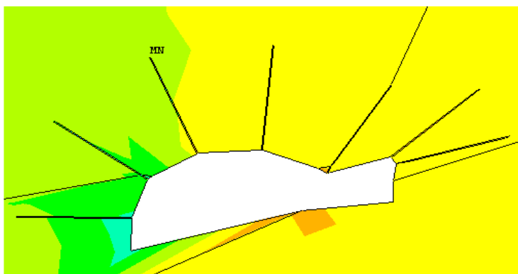
Рис. 12. Проявления горного давления ( \delta_y ) вокруг вентиляционной выработки
