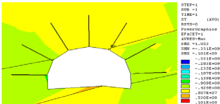
Рис. 11. Проявления горного давления в конвейерной выработке ( \bar{\sigma}_y ) при технологии очистных работ с возвратно-точной схемой проветривания
