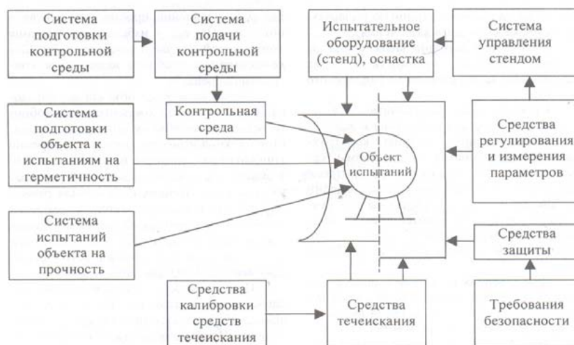
Рис. 3. Типовая структурная схема технологического процесса испытаний на герметичность
