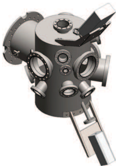
Рис. 1. Общий вид установки молекулярно-лучевой эпитаксии с магнитооптическим эллипсометрическим комплексом
