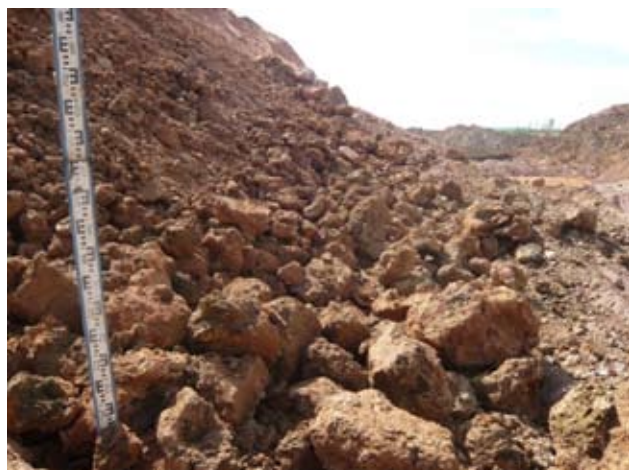
Рис. 1. Отвал глинистых песков после выемки драглайном ЭШ 6.45
