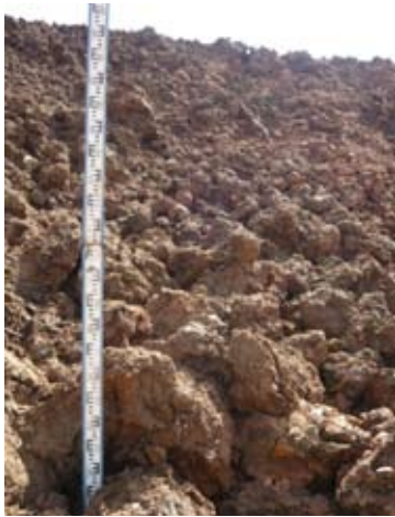
Рис. 1. Отвал глинистых песков после выемки драглайном ЭШ 6.45
