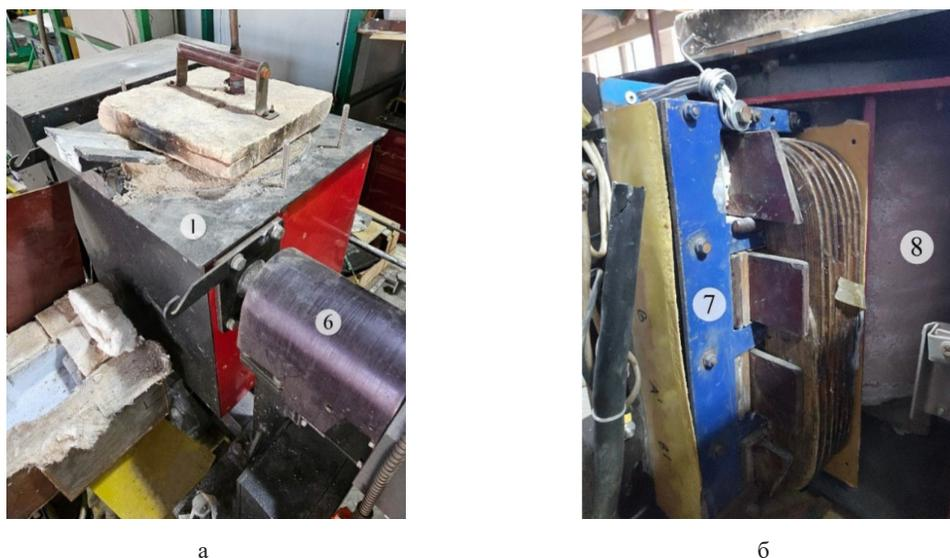
Рис. 2. Индукционная тигельная печь с МГД-перемешивателем: 1 – корпус ИТП; 6 – электропривод для поворота ИТП; 7 – МГД-перемешиватель; 8 – тигель с соленоидальной катушкой
