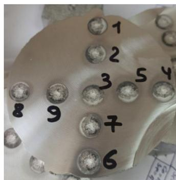
Рис. 8. Схема «прожигов» на цилиндрических образцах для анализа химического состава
