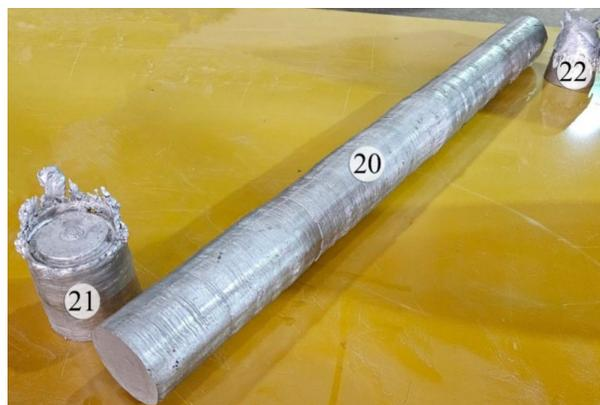
Рис. 7. Слиток после литья в ЭМК с дополнительным МГД-перемешиванием расплава: 20 – слиток; 21 – донник; 22 – литник
