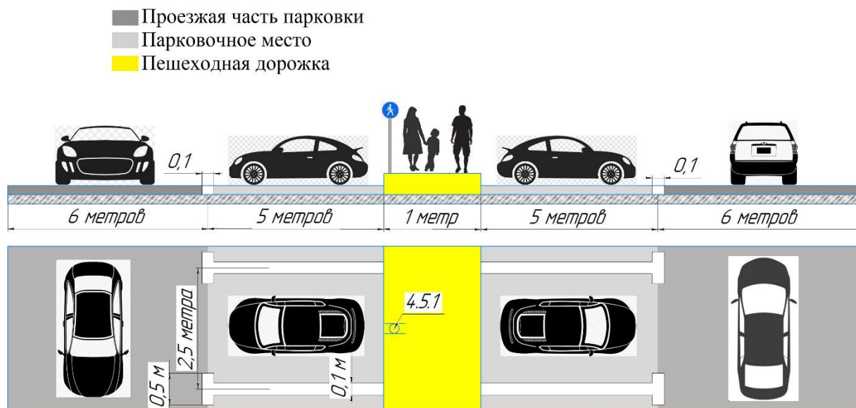
Рисунок 9.18 – Поперечный профиль пешеходной дорожки на парковке
