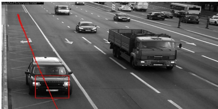
Рисунок 2.14 – Работа камеры фото/видеофиксации нарушений
