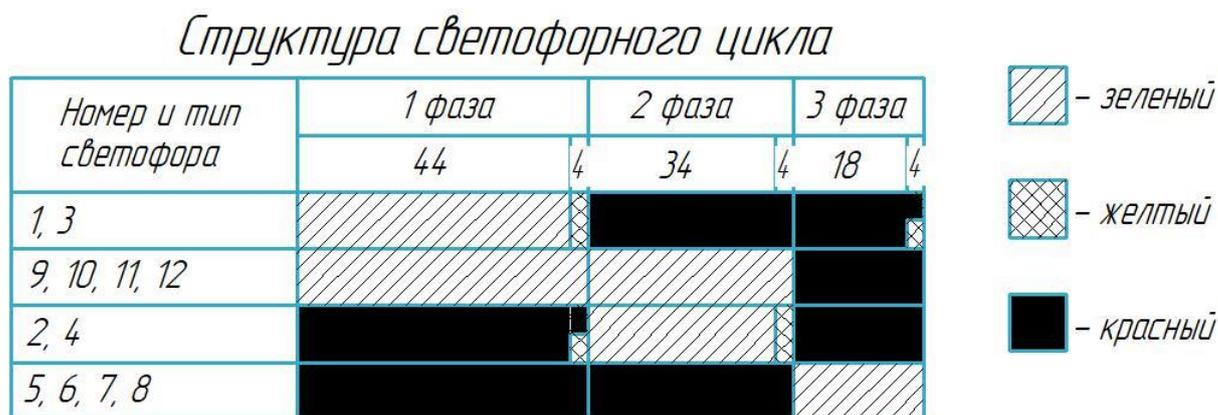
Рисунок 2.9 – Существующая структура светофорного цикла на пересечении ул. Кирова – ул. Пушкина
