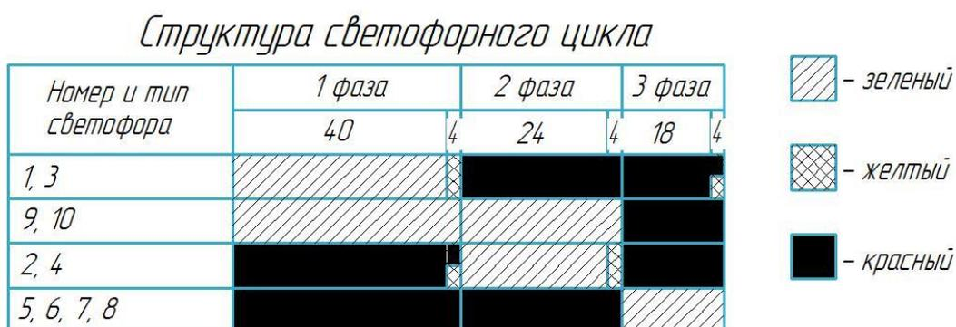
Рисунок 2.18 – Существующая структура светофорного цикла на пересечении ул. Гагарина – ул. Пушкина
