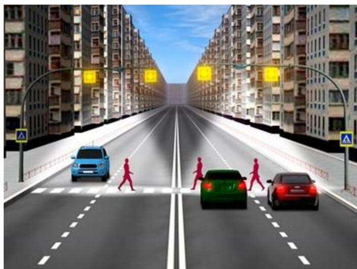
Рисунок 2.36 – Пешеходный переход с предупреждающей индикацией.
