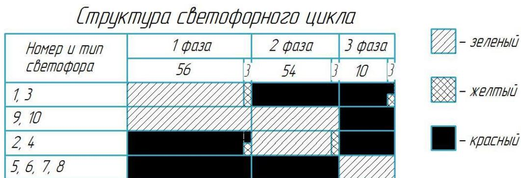
Рисунок 2.23 – Расчетная структура светофорного цикла на пересечении ул. Гагарина – ул. Суворова
