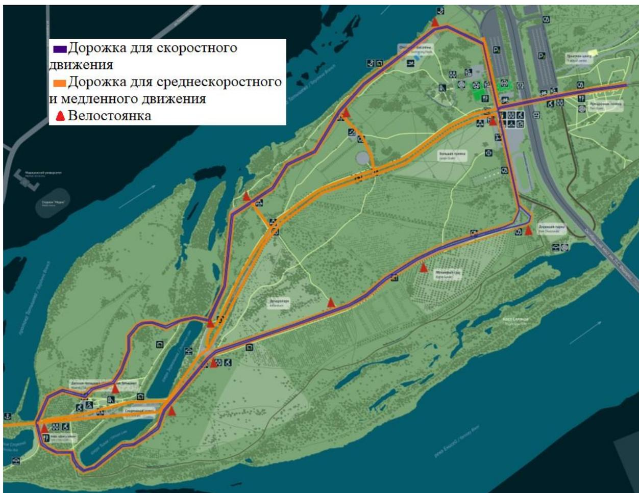
Рисунок 5.9 – Второй вариант проектируемой схемы ОДД во внутриварковой зоне
