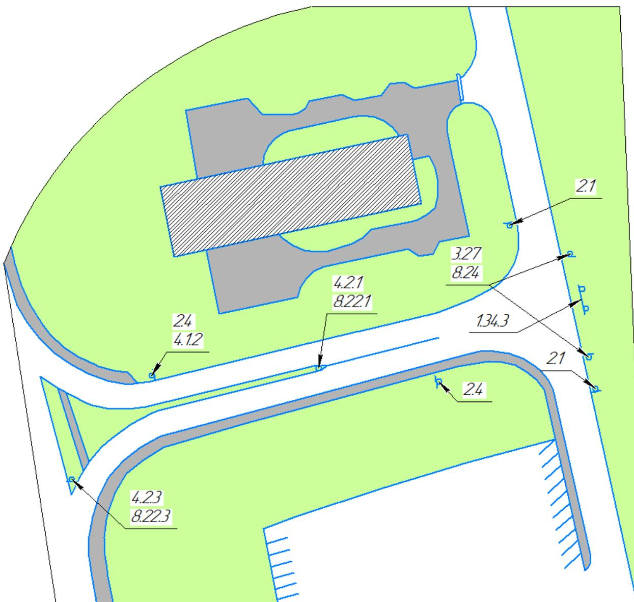
Рисунок 2.19 – Схема существующей ОДД Т-образного перекрестка
