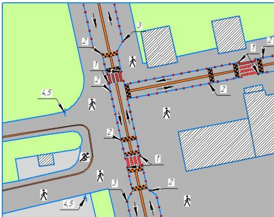
Рисунок 6.5 – Проектируемая схема ОДД вело-пешеходного узла №2
