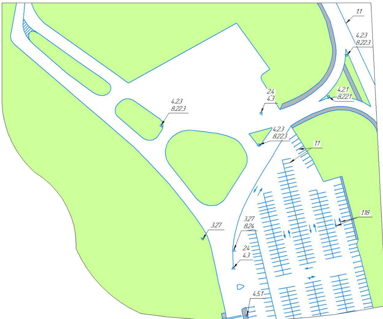
Рисунок 2.17 – Схема существующей ОДД кольцевой развязки при въезде на остров
