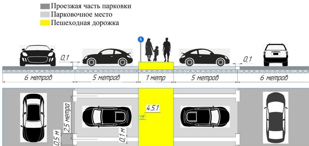
Рисунок 9.18 – Поперечный профиль пешеходной дорожки на парковке
