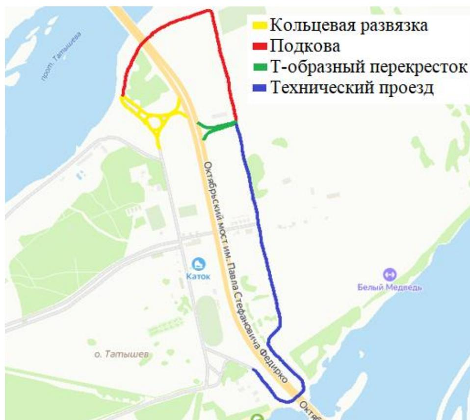
Рисунок 2.16 – Схема участков автомобильных дорог на острове Татышев
