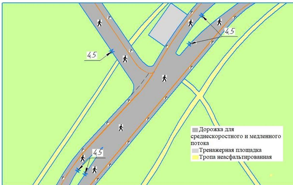
Рисунок 7.3– Проектируемая схема ОДД пешеходного узла №6
