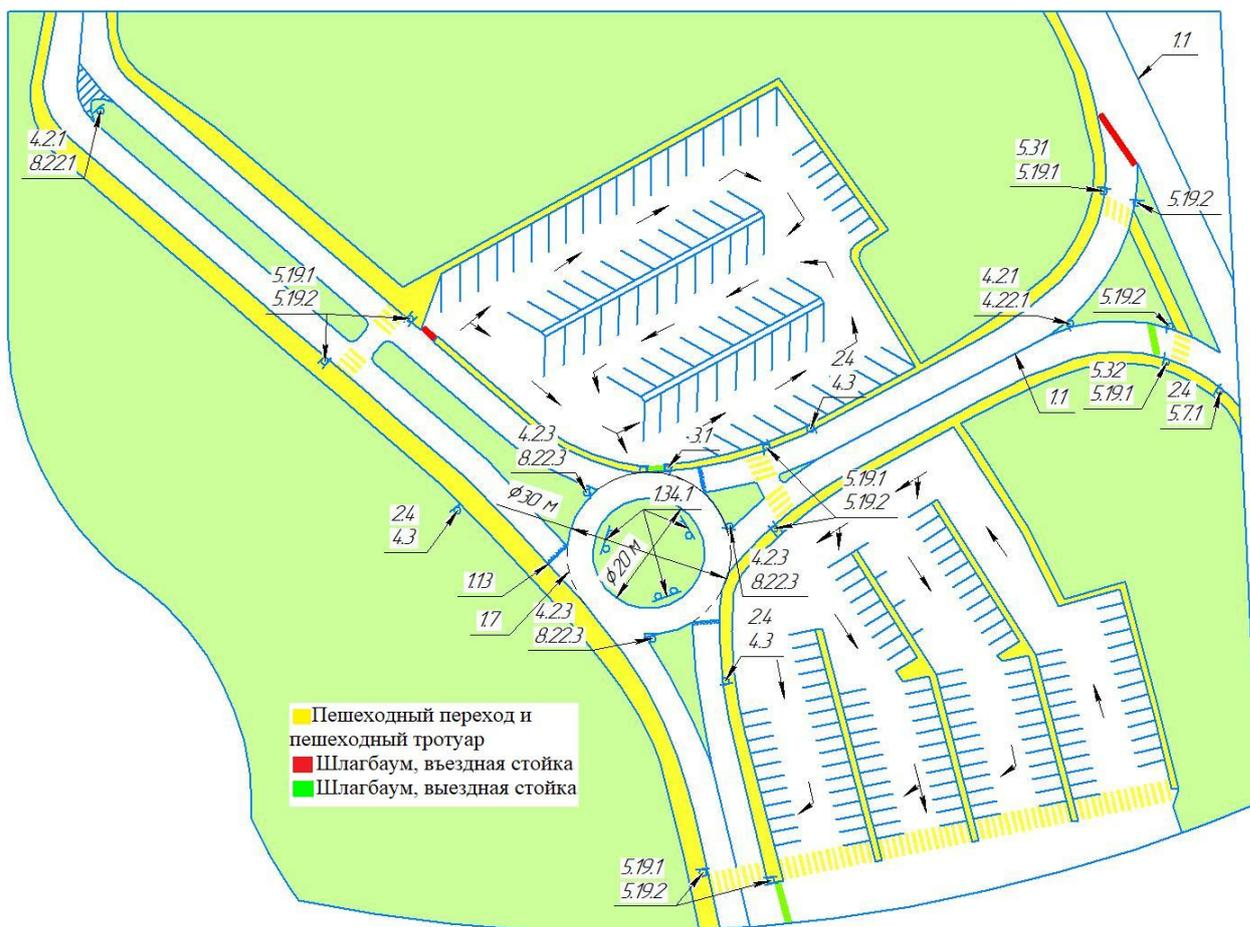
Рисунок 10.6 – Проектируемая схема ОДД кольцевой развязки
