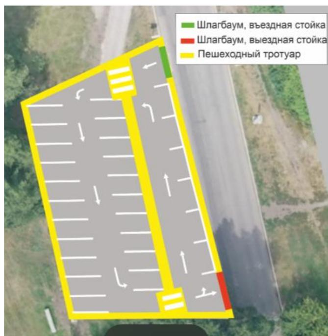
Рисунок 9.21 – Проектируемая схема ОДД парковки №3
