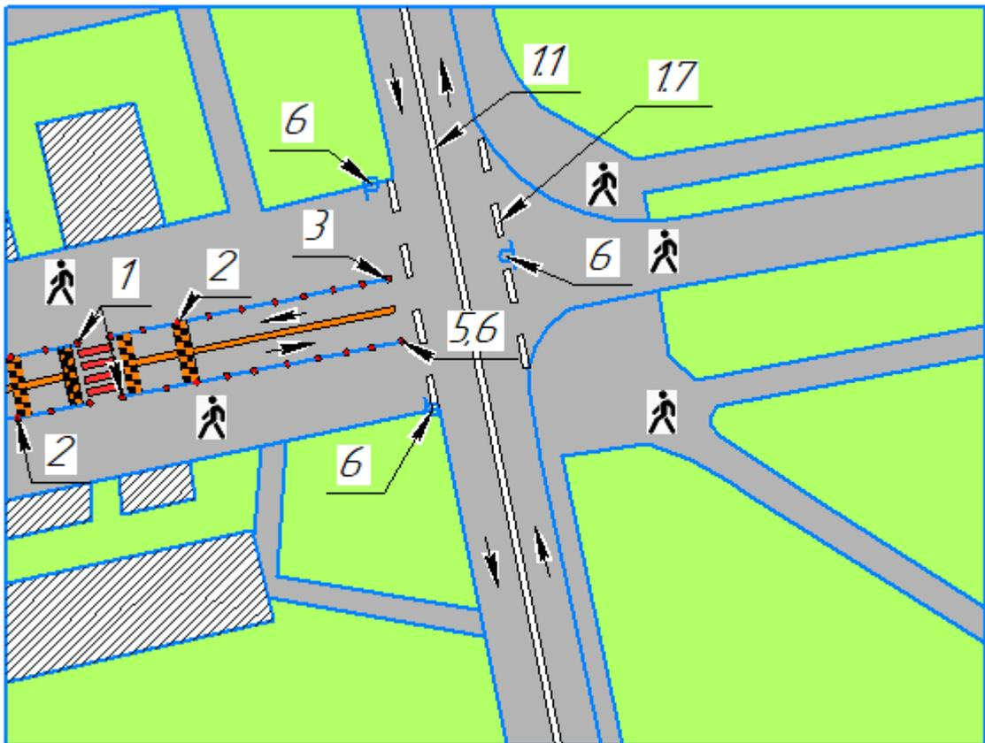
Рисунок 6.6 – Проектируемая схема ОДД вело-пешеходного узла №1
