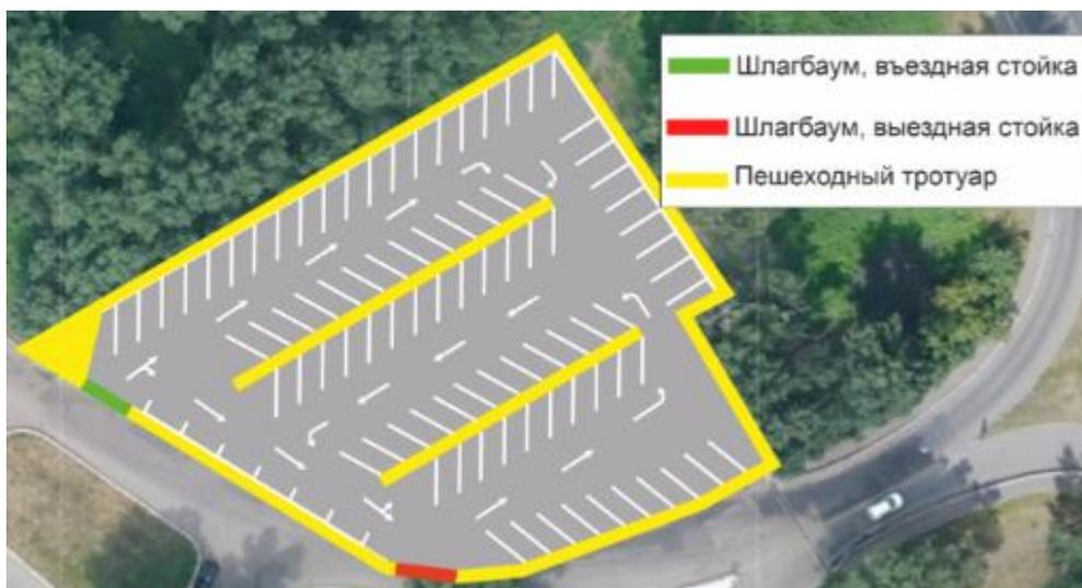
Рисунок 9.20 – Проектируемая схема ОДД парковки №2
