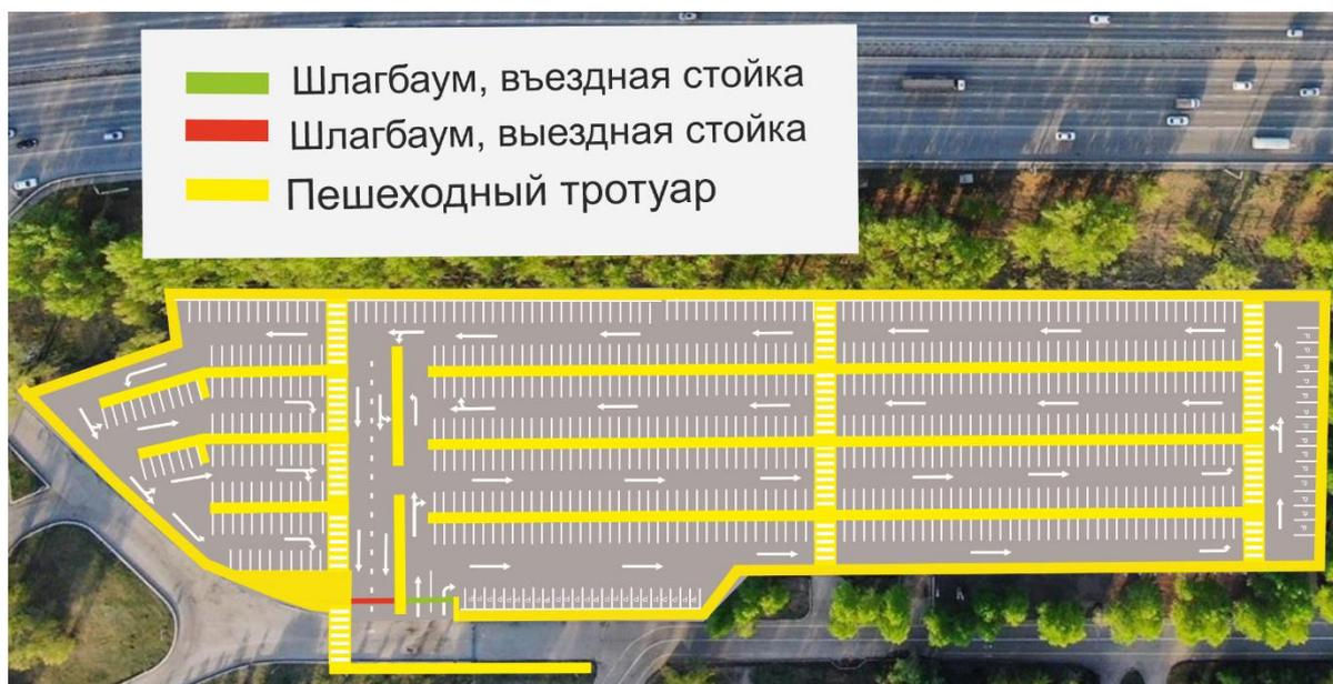
Рисунок 9.19 – Проектируемая схема ОДД парковки №1
