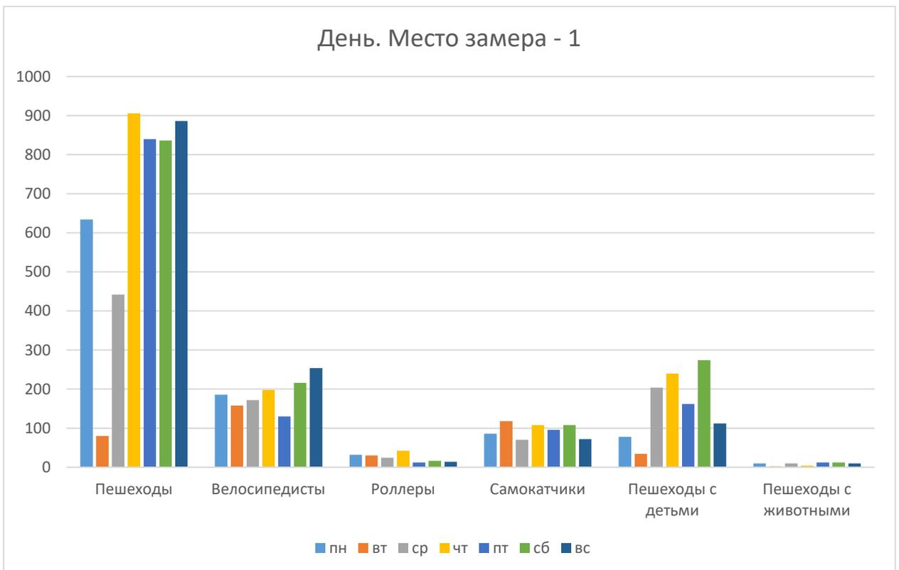
Рисунок 3.20 – Интенсивность потоков днем в точке 1
