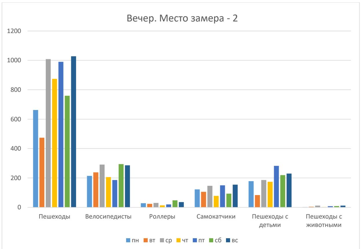
Рисунок 3.24 – Интенсивность потоков вечером в точке 2
