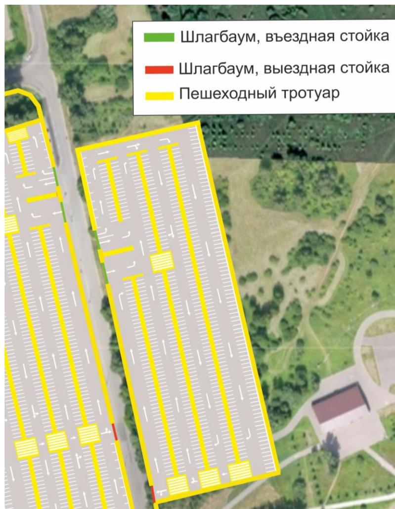
Рисунок 9.24 – Проектируемая схема ОДД дополнительной парковки
