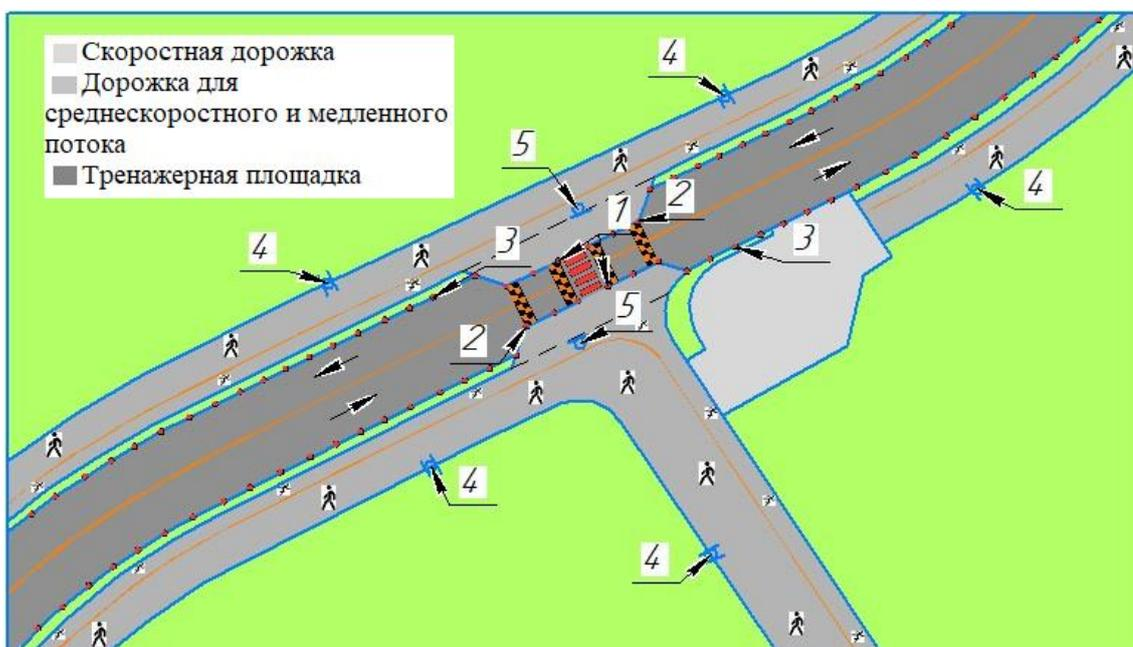
Рисунок 7.2 – Проектируемая схема ОДД вело-пешеходного узла №4
