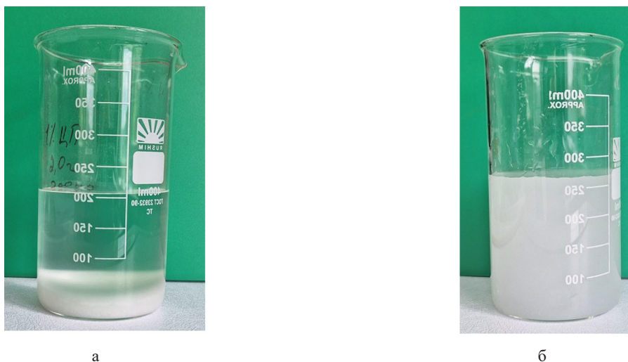
Рис. S 3. Фотографии суспензии целлюлозы в воде: а – исходная суспензия; б – после ультразвуковой активации
