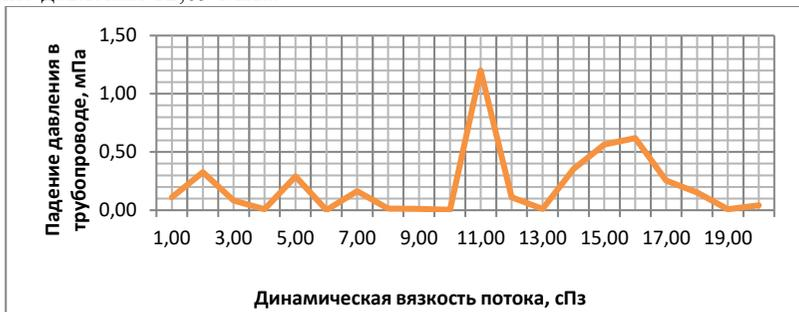
Рисунок 8 – Графическая зависимость падения давления в трубопроводе от вязкости потока, сПз
