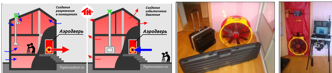
Рис. 2. Совместное использование аэродвери и тепловизора.
