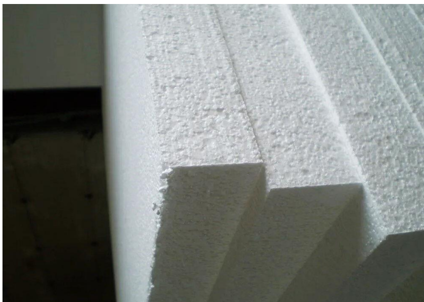
Фотография 2.2.2 – Плиты пенополистирол ПСБ-С-М-25.
