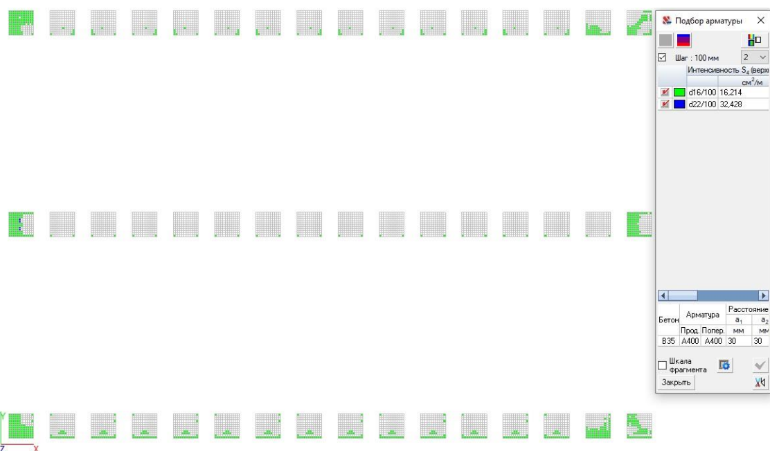
Рисунок 3.13 – Интенсивность верхнего армирования фундаментов по ОУ По результатам расчета принимаем следующую арматуру таблица 3.4.
