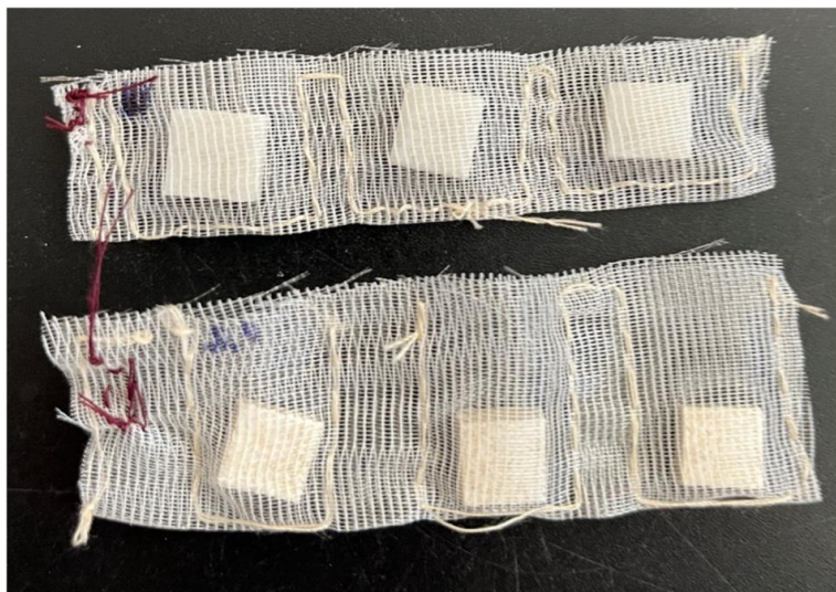
Рисунок 1 - Исходные образцы полимеров П(ЗГБ) (сверху) и П(ЗГБ)/БЦ 50/50% (снизу) в мешочках из органзы
