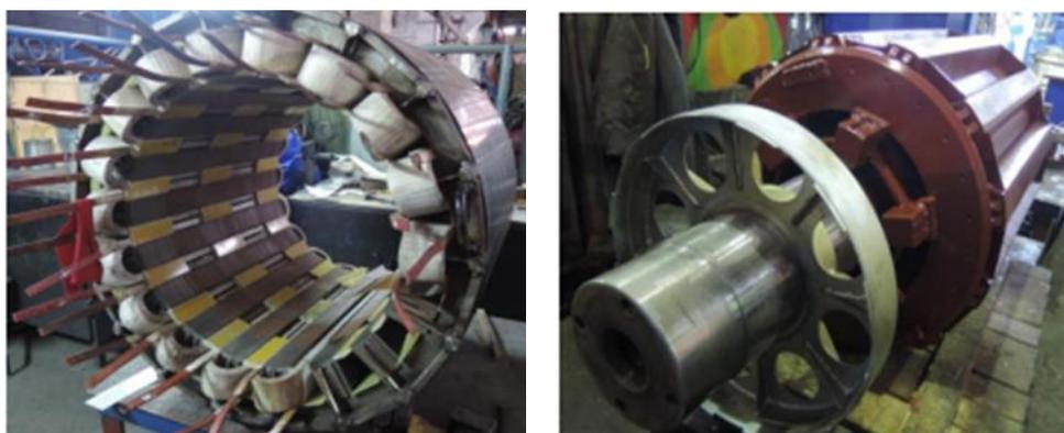
Рисунок 2.5 – Пакет статора с обмотками и ротора
