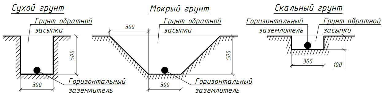
Рисунок 6.1 – Типы траншей для прокладки горизонтального заземлителя
