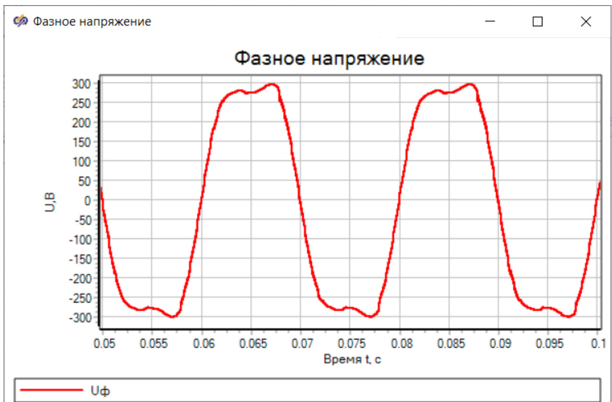
Рисунок 67 – Фазное напряжение при k_n=40\% и n=10 , Y/Y
