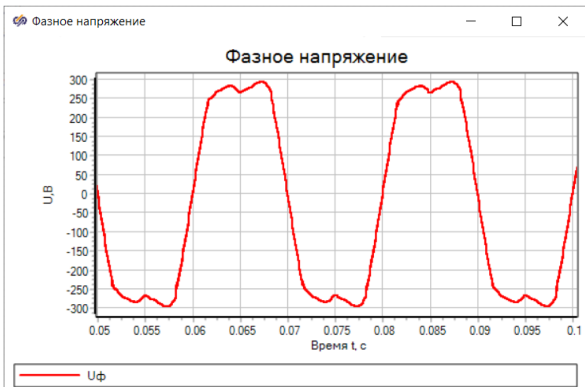
Рисунок 85 – Фазное напряжение при k_n=70\% и n=100 , Y/Y
