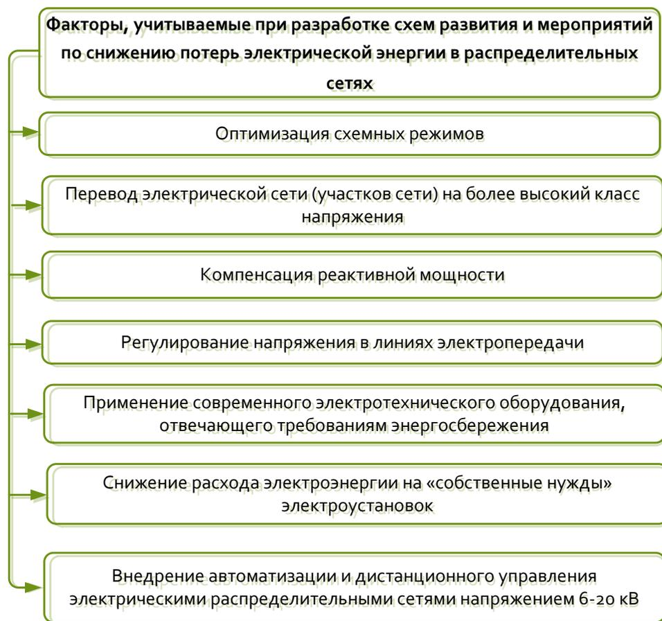
Рисунок 1.6 – Факторы, учитываемые при разработке схем развития
