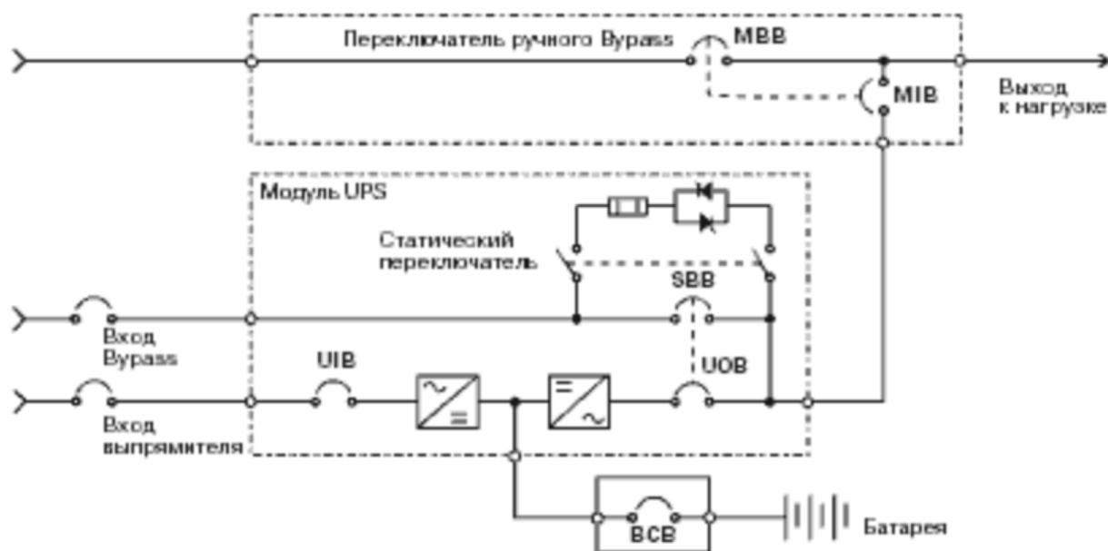
Рис. 3.1. Одномодульный ИБП
