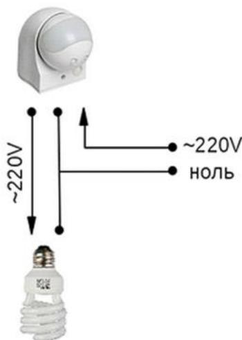
Рисунок 8 - Схема подключения датчика движения
