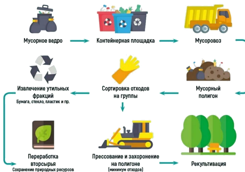
Рисунок 2.2 – Схема производственного цикла процесса переработки ТБО в ООО «Росттех»
