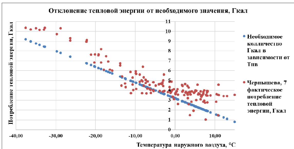
Рисунок 7 – График отклонения потребления тепловой энергии в зависимости от температуры наружного воздуха здания по адресу Чернышева 7
