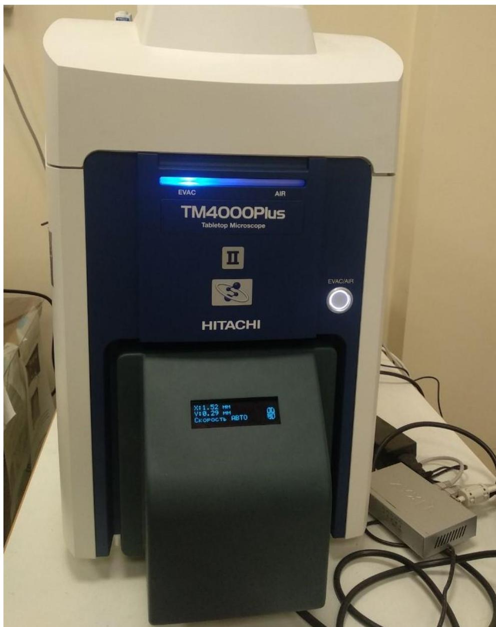
Рисунок 14 – Сканирующий-электронный микроскоп TM4000Plus
