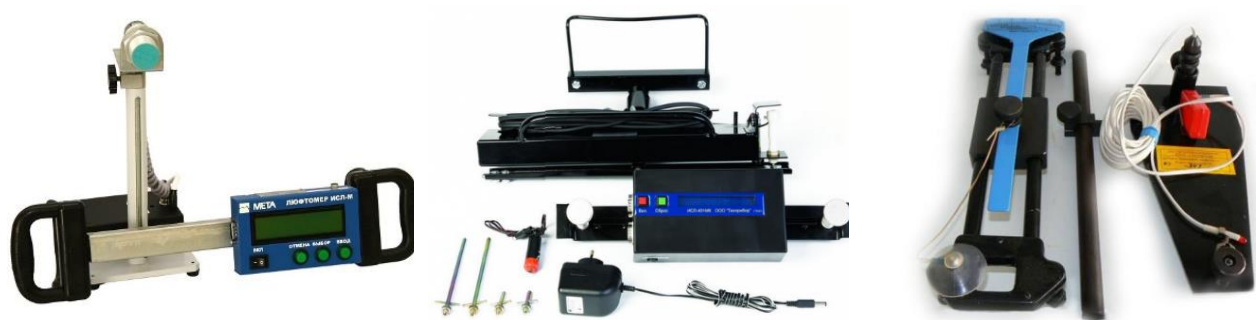
1 2 3 1 – Люфтомер рулевого управления электронный ИСЛ-М (Мета); 2 – Люфтомер ИСЛ-401М; 3 – Механический люфтомер К 524М.
