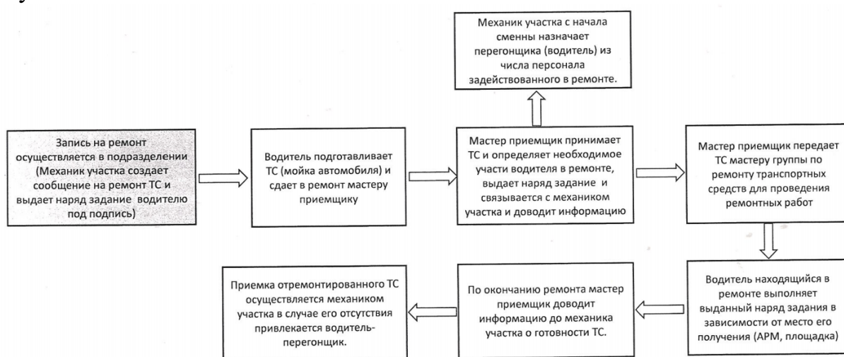
Рисунок 1.9 – Схема передачи транспортного средства в ТО и ТР
