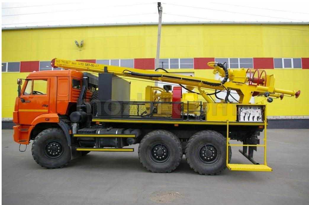
Рисунок 1.1 - Буровая установка УРБ-2А-2
