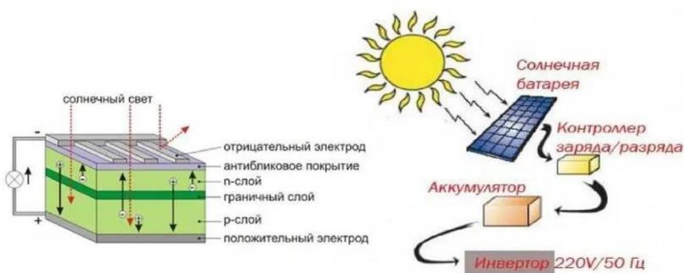
Рисунок 1.7 - Схема работы технологии и устройство полупроводника
