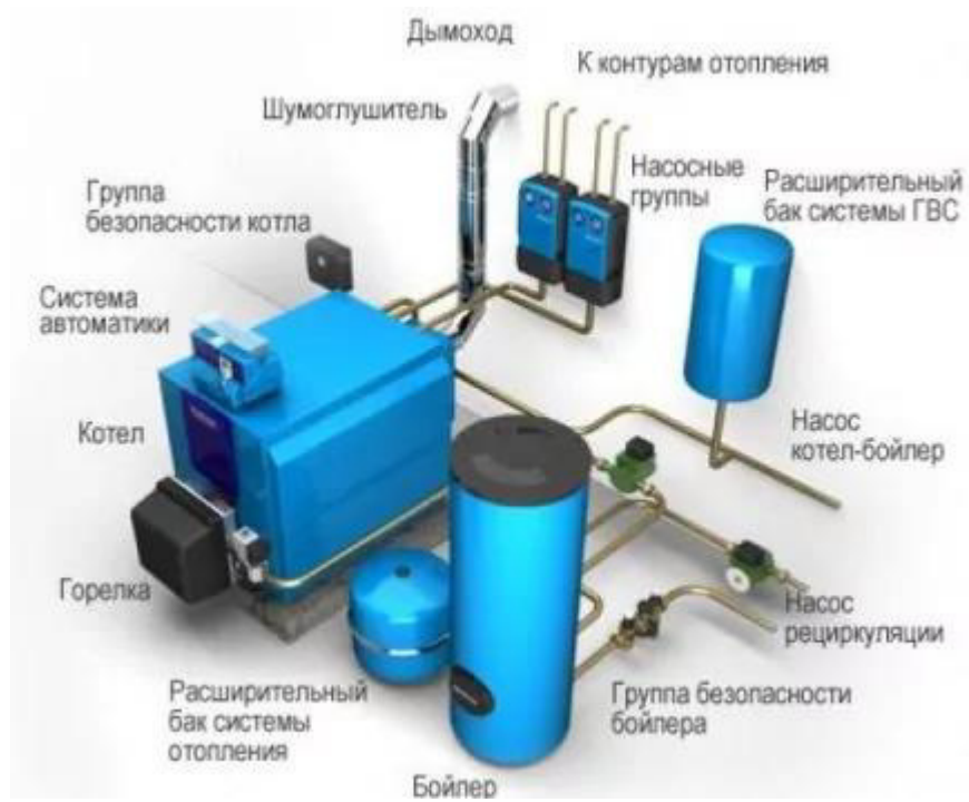
Рисунок 7 – принципиальная схема котельной.
