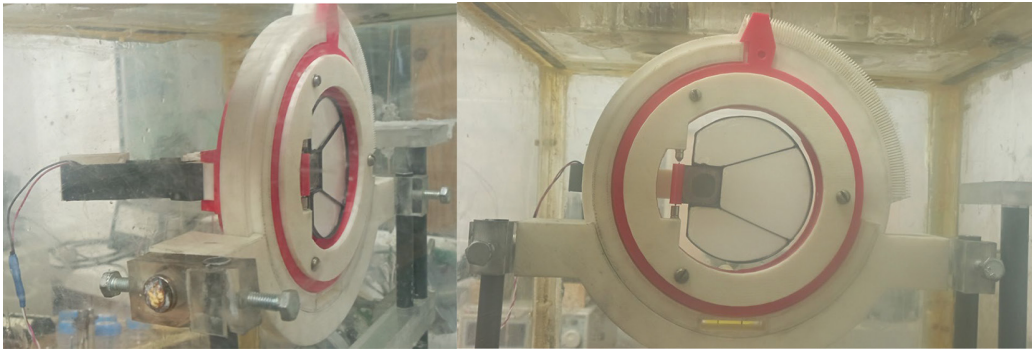
Рис. 4. Фотография стенда измерения тяги, установленного в вакуумной камере
