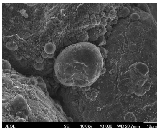
Рис. 6. РЭМ-изображения поверхности шлифа пеноалюминия с 10 % \text{CaCO}_3 при 1000\times увеличении
