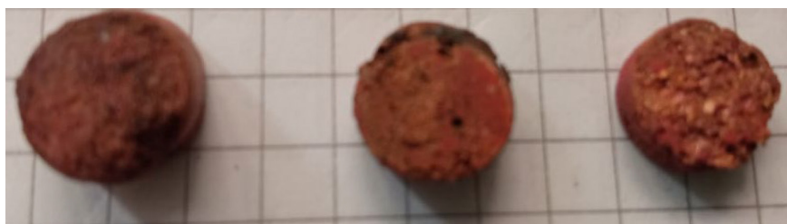
Рис. 10. Образцы пеномеди диаметром 10 мм с порофором CaCO 3
