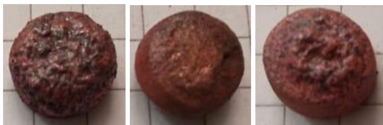
Рис. 7. Образцы пеномеди диаметром 10 мм с порофором \text{CaCO}_3
