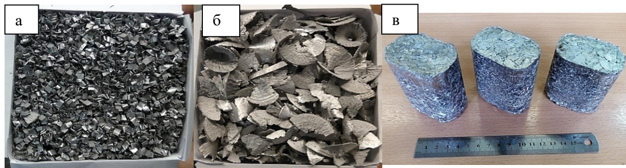
а – сыпучая мелкая стружка; б – хлопьевидная крупная стружка; в – брикетированная стружка
