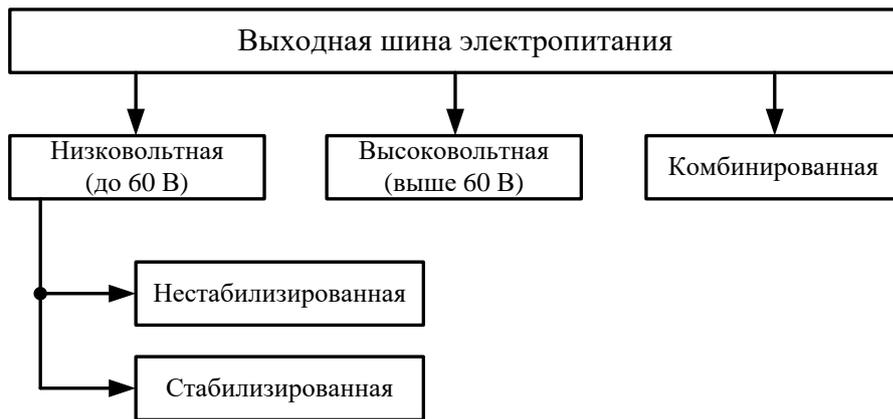
Рисунок 1.2 – Классификация ЭПК по уровню напряжения
