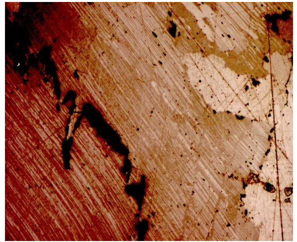
Рисунок 5.8 – мраморизованные известняки с включениями пирита ( белое) с размерами до 0,6 мм. Прозрачный шлиф. Ув.25 x
