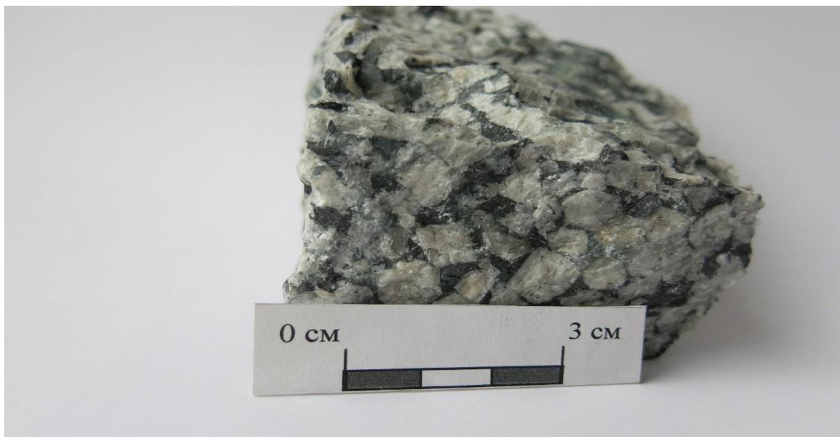
Рис.3.40 – Уртит. текстура массивная, неоднородная, зернистая; трахитовая макроструктура. Образец 3а. Горизонт 630м
