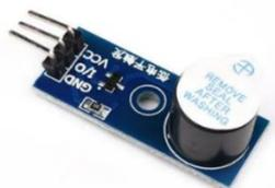
Рисунок 13 – Модуль пьезоэлектрического динамика
