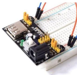
Рисунок 17 – MB102 с макетной платой
