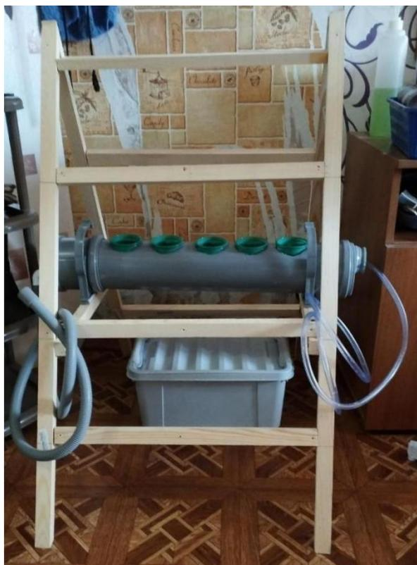
Рисунок 3.2 – Собранная гидропонная установка
