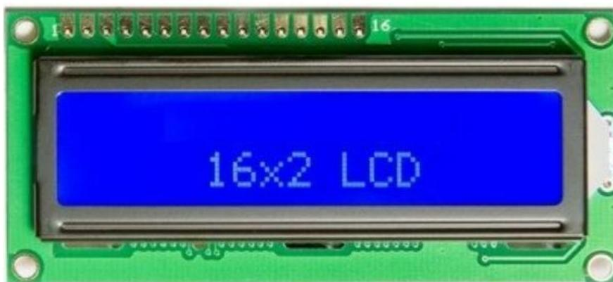
Рисунок 2.4 – Жидкокристаллический дисплей HD44780
