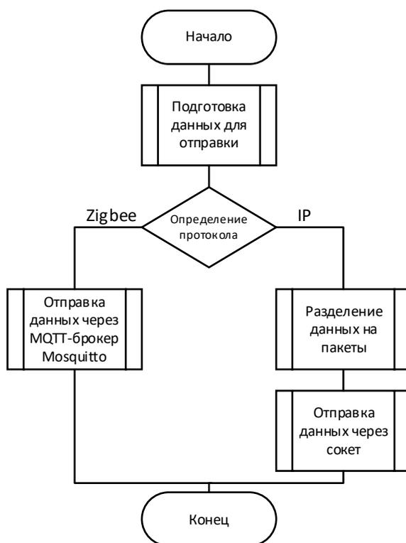
Рисунок 14 – Алгоритм работы модуля инкапсуляции данных
