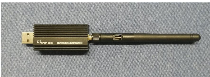
Рисунок 9 – USB-стик Sonoff Zigbee 3.0 USB Dongle Plus
