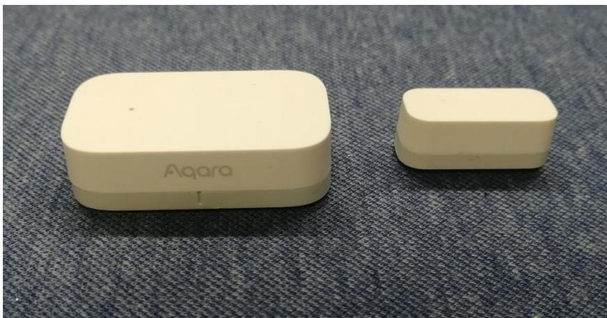
Рисунок 10 – Датчик открытия дверей и окон Aqara Door and Window Sensor
