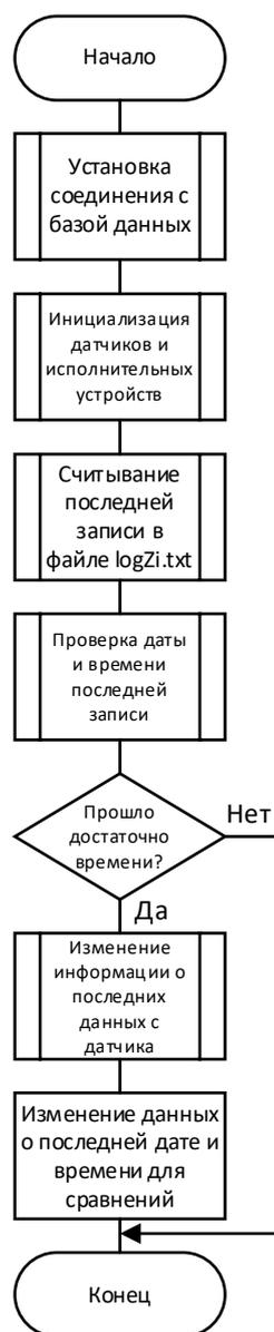
Рисунок 13 – Алгоритм работы модуля декапсуляции данных из протокола Zigbee
