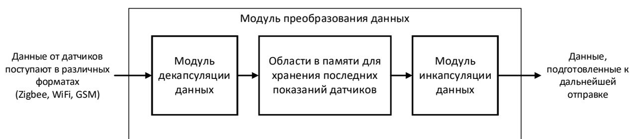
Рисунок 6 – Принцип работы модуля преобразования данных
