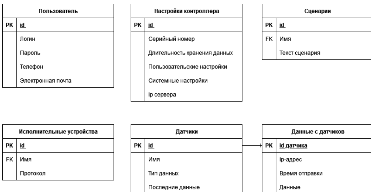
Рисунок 4 – Структура базы данных на контроллере
