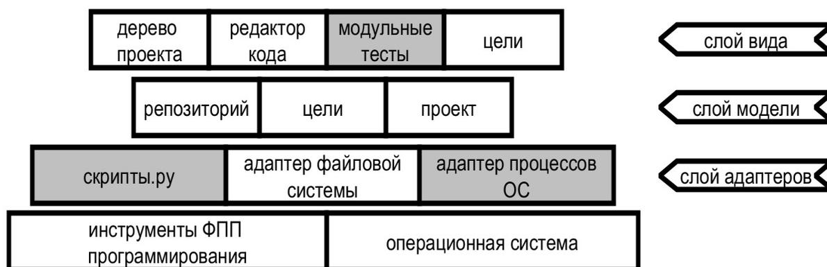
Рисунок 2.1 — Слои и модули среды разработки ФПП программ
