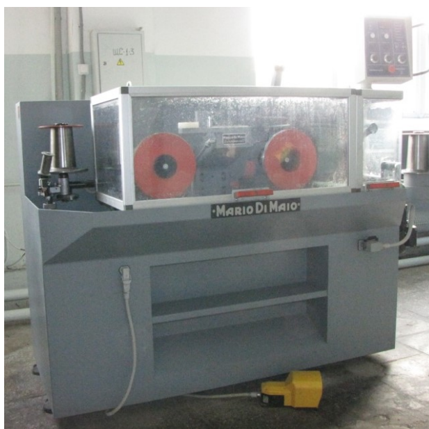
Рисунок 2.2 - Общий вид волочильного стана 10 NFS TRONIC
