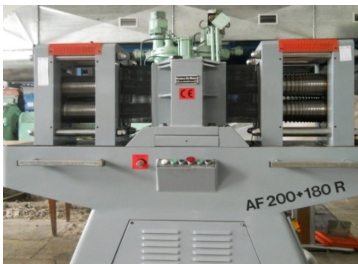
Рисунок 2.1 – Общий вид сортопрокатного AF 200+180R (а) и листопркатного стана LS 400 x 240 (б)
