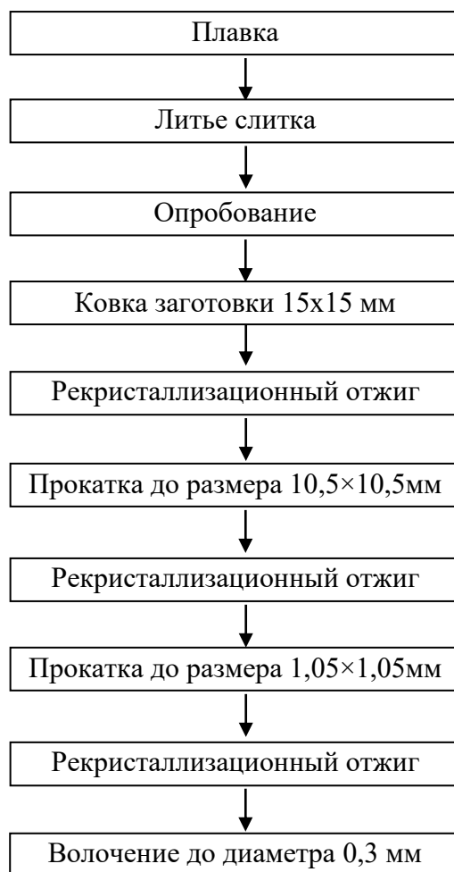
Рисунок 4.1 - Схема действующей технологии получения проволоки из сплавов палладия
