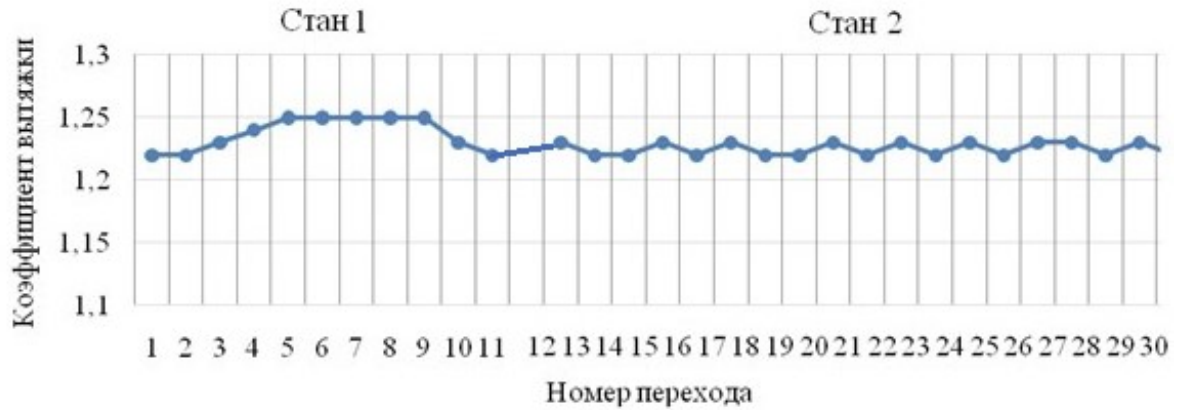
Рисунок 4.18 - Изменение единичного коэффициента вытяжки \lambda_{ед.} по предлагаемому режиму волочения проволоки из сплава №7
