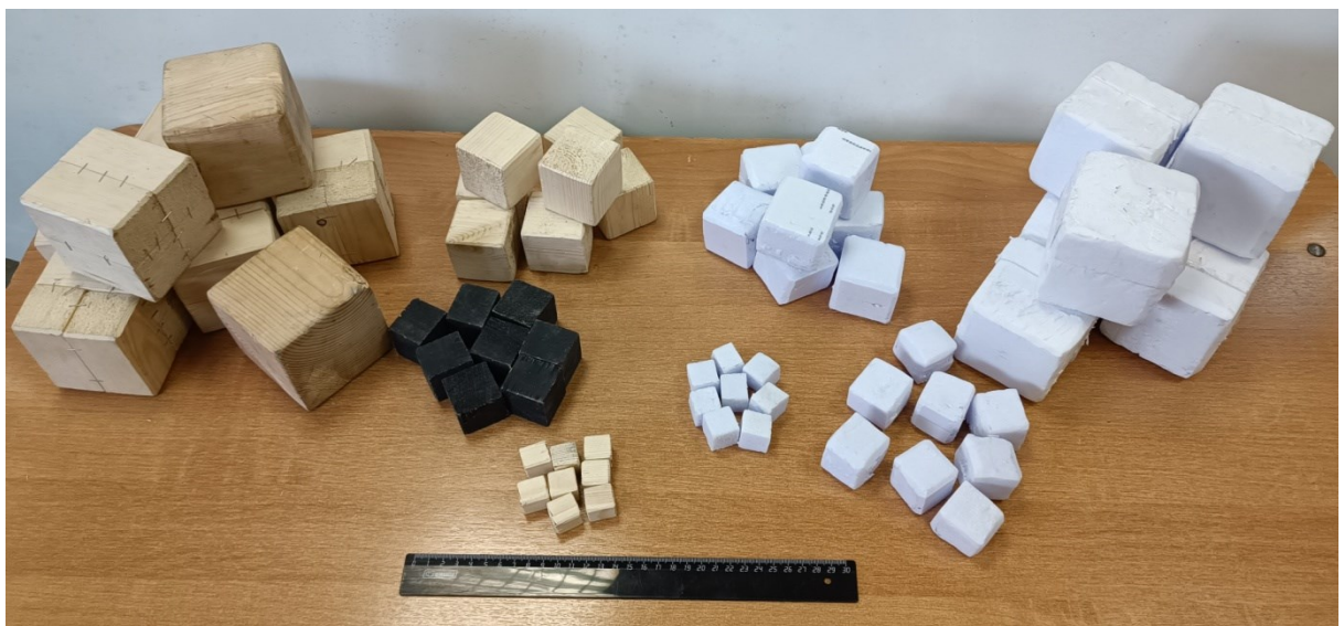
Рисунок 5.6 – Сортируемый материал для испытаний модели струнного грохота
