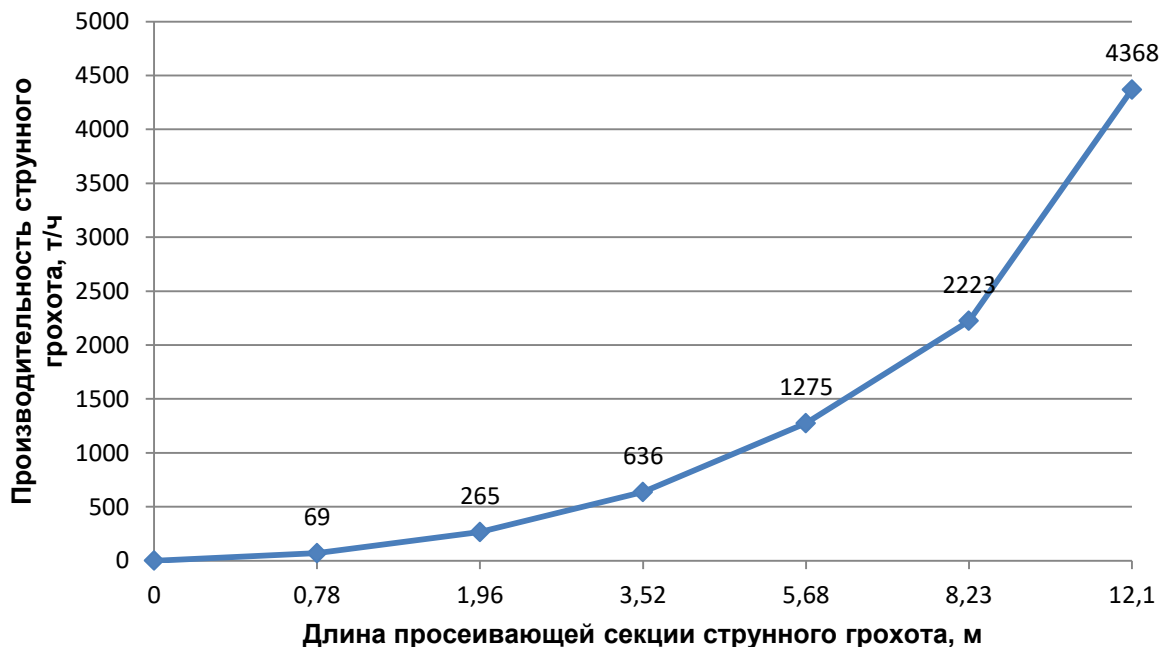
Рисунок 4.27 – Зависимость производительности струнного грохота от длины его просеивающих секций
