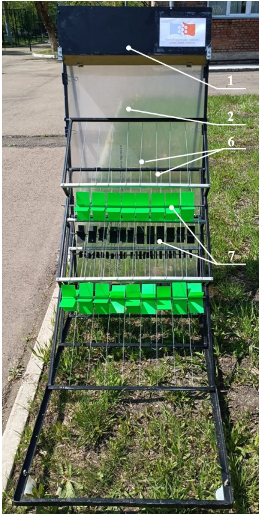
Рисунок 5.9 – Экспериментальная модель струнного ступенчатого грохота (вид спереди):
