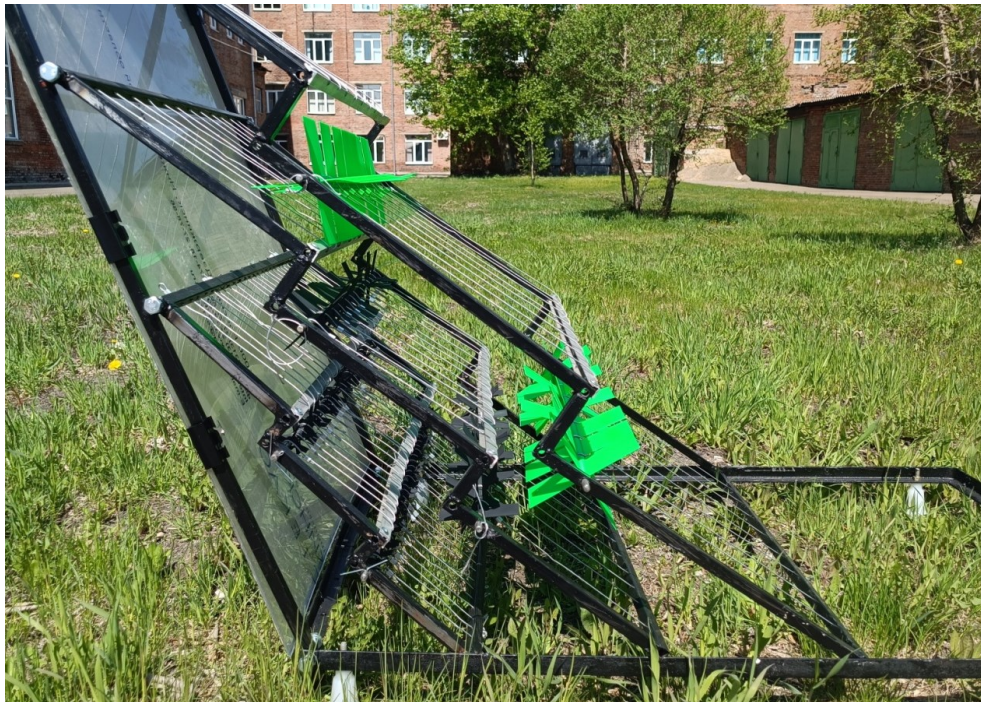
Рисунок 5.11 – Ступени, кантователи и струны просеивающих секций ССГ (вид сбоку)
