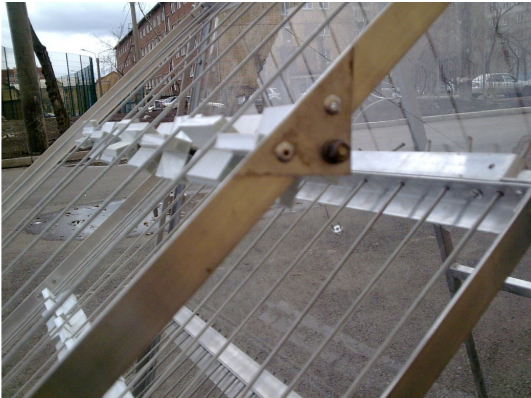
Рисунок 5.4 – Кантователи и струны просеивающих секций СГ (вид сбоку)
