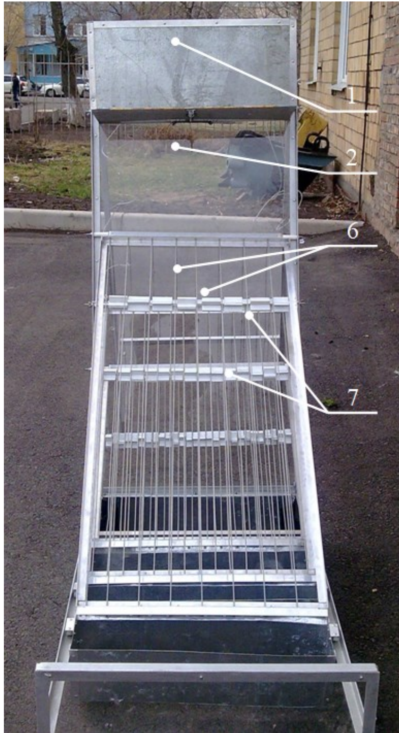
Рисунок 5.2 – Экспериментальная модель струнного грохота (вид спереди): 1 – загрузочный бункер; 2 – передняя стенка; 6 – струны просеивающих секций; 7 – кантователи
