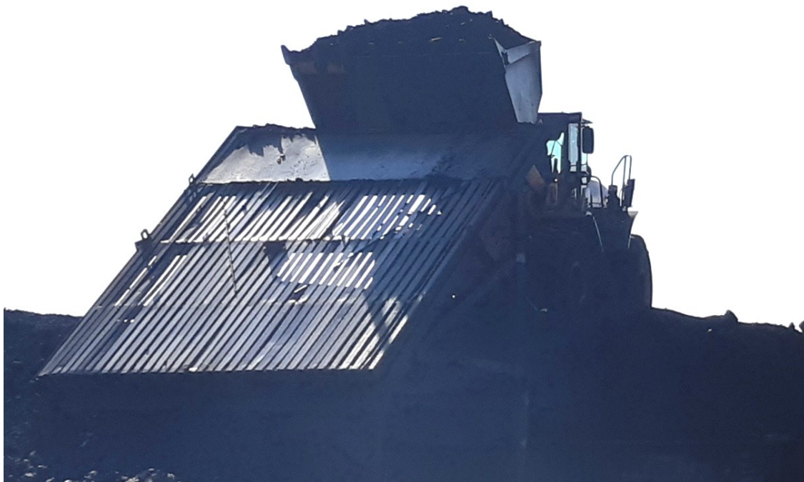
Рисунок 1.15 – Момент загрузки колосникового грохота рядовым углем колесным погрузчиком
