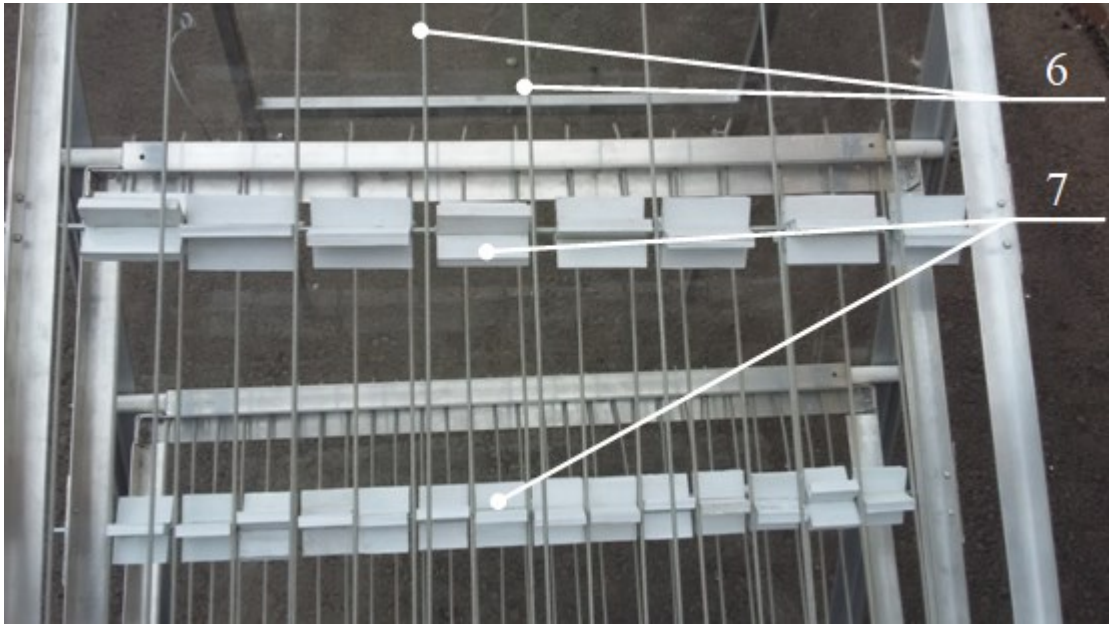
Рисунок 5.3 – Кантователи и струны просеивающих секций СГ (вид сверху): 6 – струны просеивающих секций; 7 – кантователи
