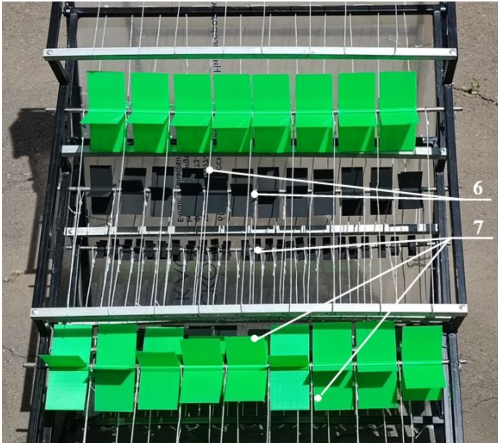
Рисунок 5.10 – Кантователи и струны просеивающих секций ССГ (вид сверху): 6 – струны просеивающих секций; 7 – кантователи
