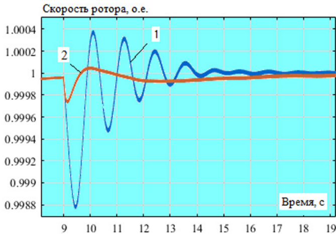
Рис. 18. Скорость вращения ротора генератора при подключении дополнительной тяговой нагрузки: обозначения 1 и 2 соответствуют рис. 4
