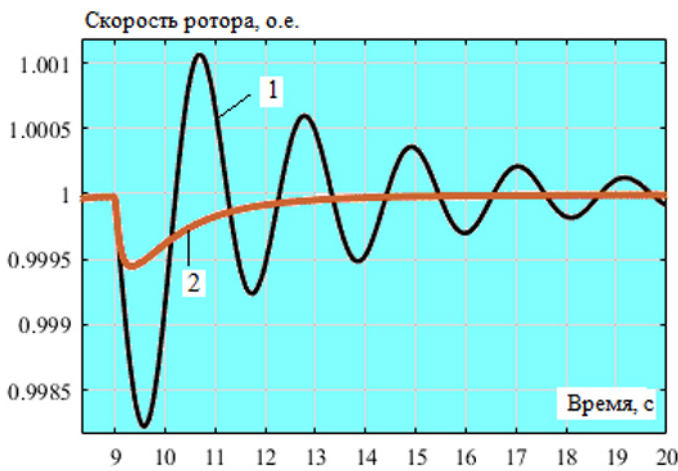
Рис. 5. Скорость вращения ротора генератора при подключении дополнительной нагрузки: обозначения 1 и 2 соответствуют рис. 4
