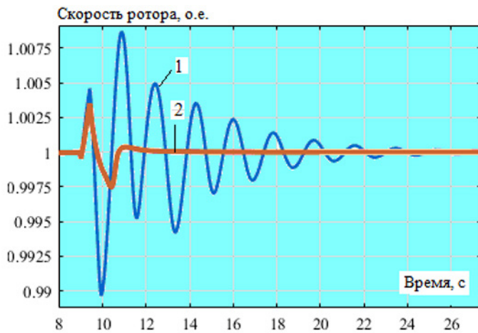
Рис. 13. Скорость вращения ротора генератора при КЗ с последующим его отключением: обозначения 1 и 2 соответствуют рис. 4
