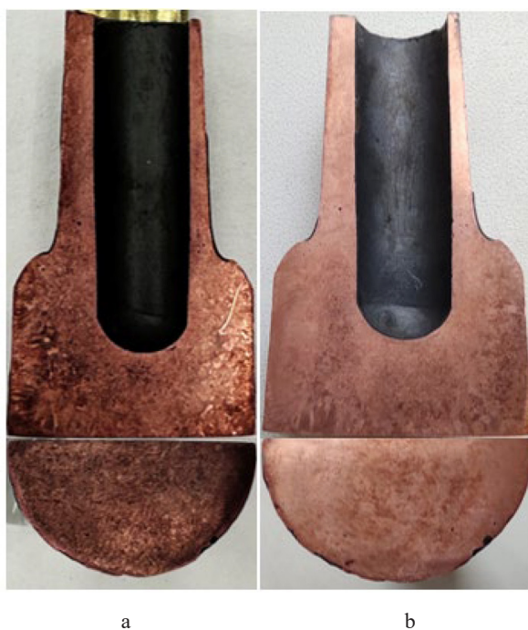
Рис. 9. Макроструктура литых – штампованных электродов: (а) литье – штамповка – закалка; (б) литье – штамповка – закалка – старение
