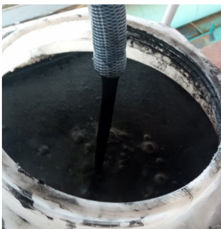
Рис. 2. Перемешивание угольной пульпы с помощью насоса
