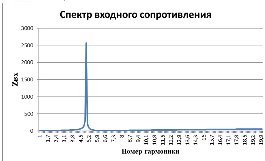
Рисунок 7 – Частотная характеристика при X_{реактора} =7,56 Ом и X_{к6} = 315 Ом
