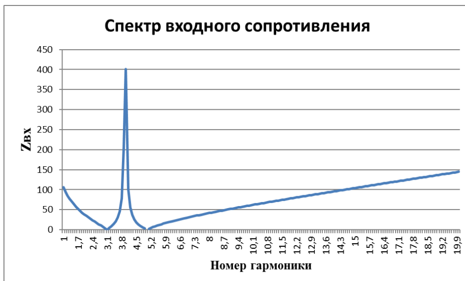
Рисунок 15 – Частотная характеристика при X_{p(350)} = 12,6 \text{ Ом} , X_{p(600)} = 19,11 \text{ Ом}
