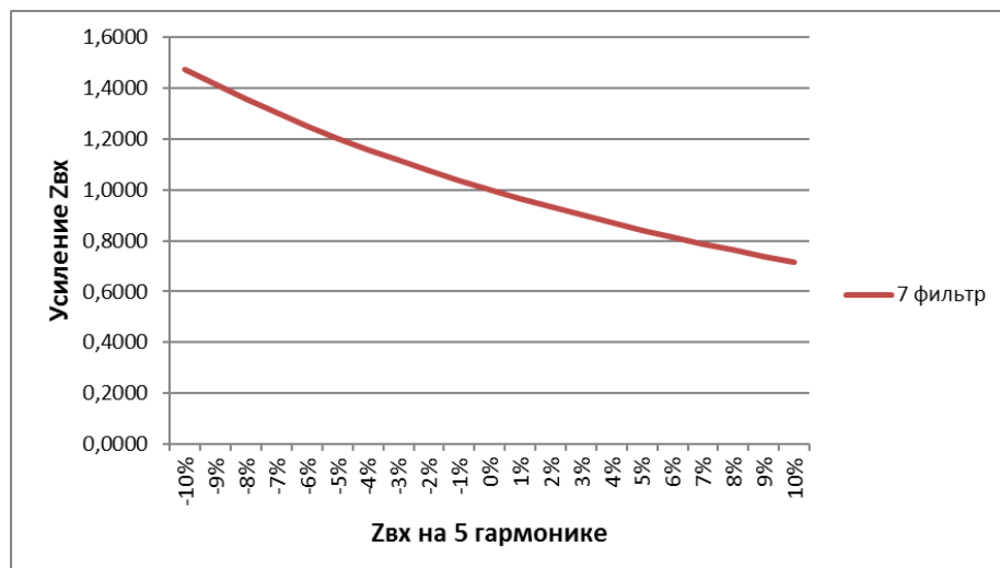
Рисунок 32 – усиление входного сопротивления на 5 гармонике
