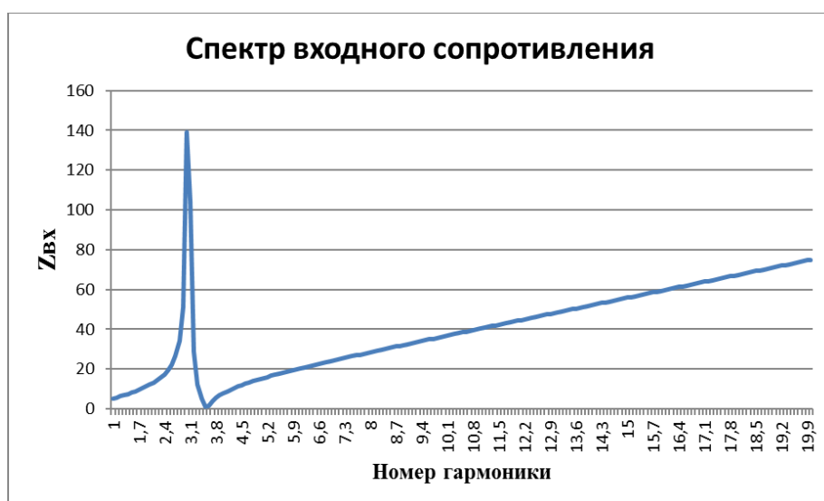
Рисунок 10 – Частотная характеристика при X_{реактора} = 14,7 Ом и X_{кб} = 183,75 Ом Таблица 9 – Входное сопротивление на различных номерах гармоник
