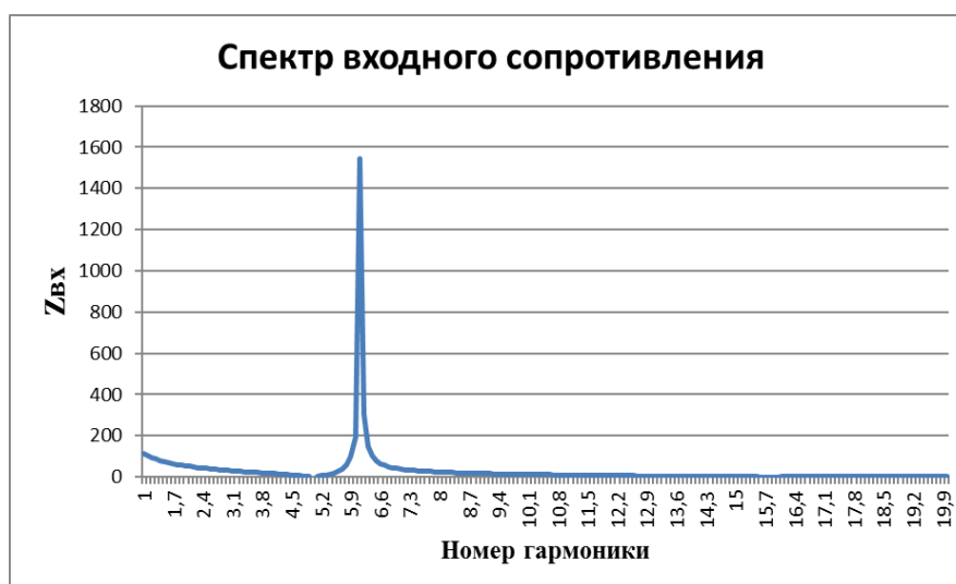
Рисунок 16 – Частотная характеристика при X_{p(350)} = 12,6 \text{ Ом} , X_{p(600)} = 0,735 \text{ Ом}
