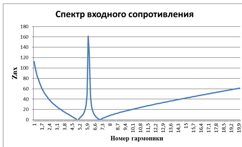
Рисунок 14 – Частотная характеристика при X_{p(350)}=6,3 Ом, X_{p(600)}=7,35 Ом
