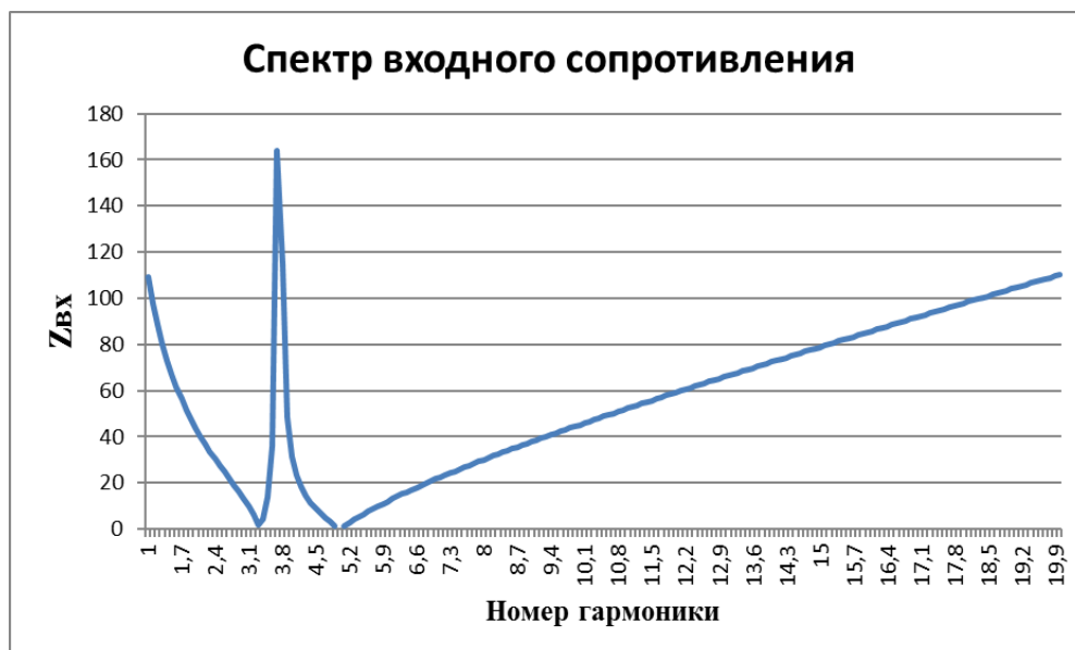
Рисунок 13 – Частотная характеристика при X_{p(350)}=28,35 Ом, X_{p(600)}=7,35 Ом
