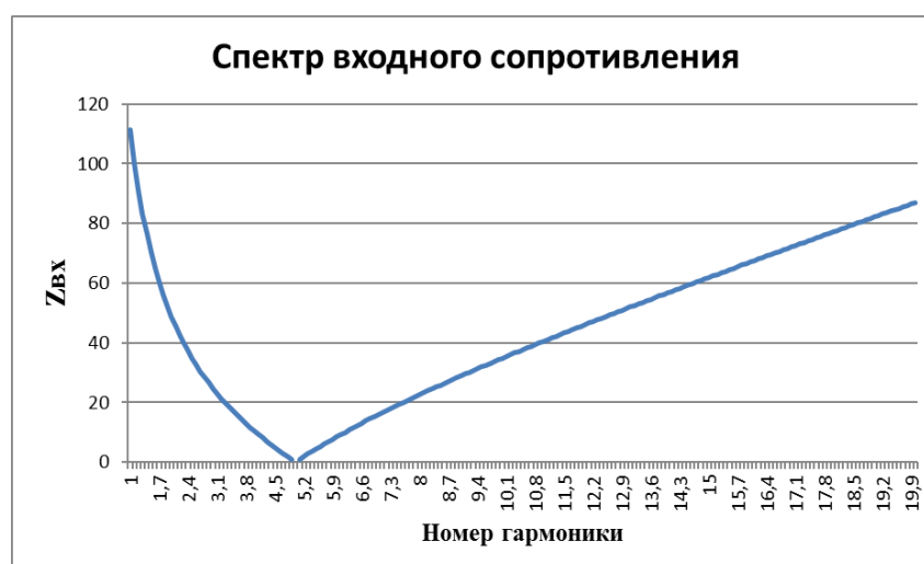
Рисунок 12 – Частотная характеристика при X_{\text{p}(350)} = 12,6 \text{ Ом} , X_{\text{p}(600)} = 7,35 \text{ Ом}
