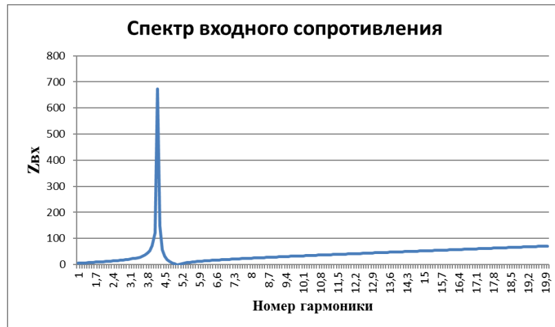
Рисунок 5 – Частотная характеристика при X_{\text{реактора}} = 12,6 \text{ Ом} и X_{\text{кб}} = 315 \text{ Ом}
