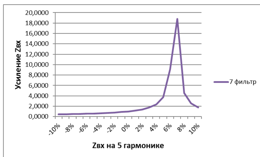
Рисунок 28 – усиление входного сопротивления на 5 гармонике
