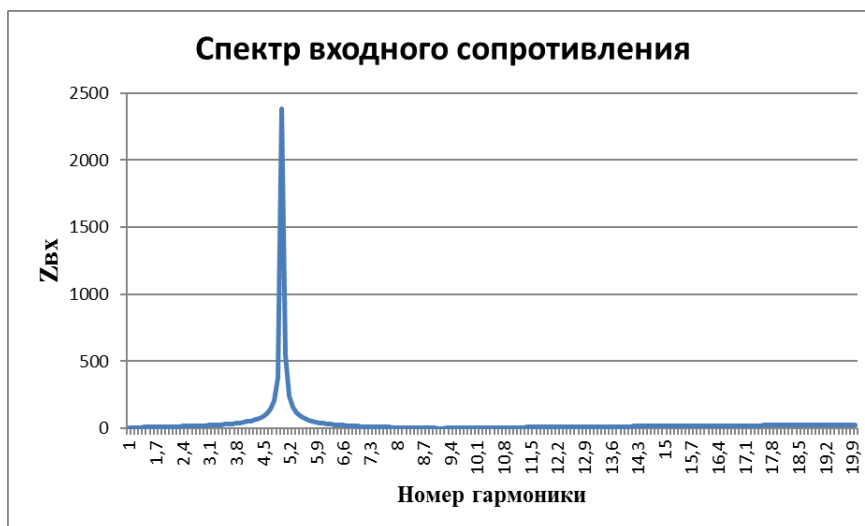
Рисунок 11 – Частотная характеристика при X_{\text{реактора}} = 2,205 \text{ Ом} , X_{\text{кб}} = 183,75 \text{ Ом}
