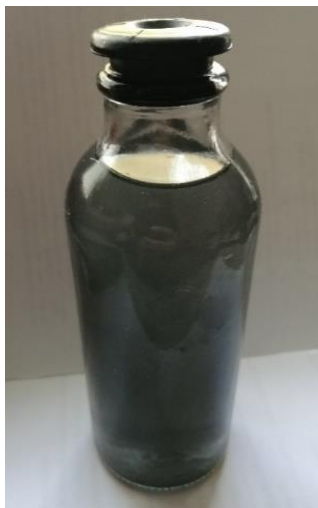
Рисунок 3.8 - Результат электрохимического процесса - колба с электролитом и частицами графита
