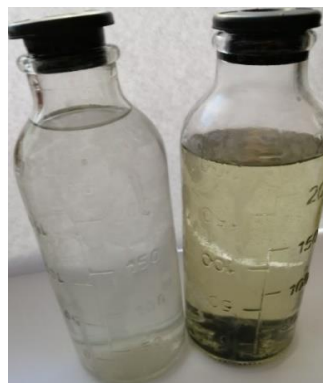
Рисунок 3.3 - Результат электрохимического процесса: колба с католитом (слева) и колба с анолитом и частицами графита (справа)
