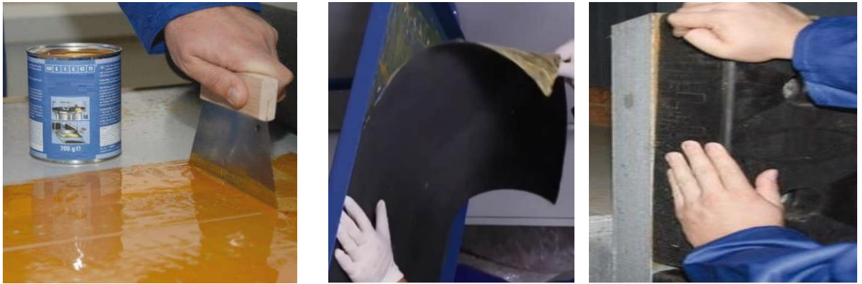
Рисунок 4.14 - Процесс приклеивания материала многофункционального покрытия на поверхность защищаемого изделия: а) подготовленный материал; б) обезжиривание; в) нанесение клея; г) выравнивание клея; д) присоединение материала; е) прижатие материала к поверхности изделия
