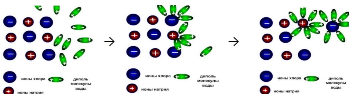
Рисунок 2.1 - Схема электролитической диссоциации электролита типа одно-одновалентного
