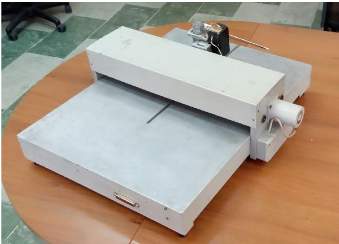
Рисунок 3 – Прототип отечественного электромеханического двухосевого агрегата
