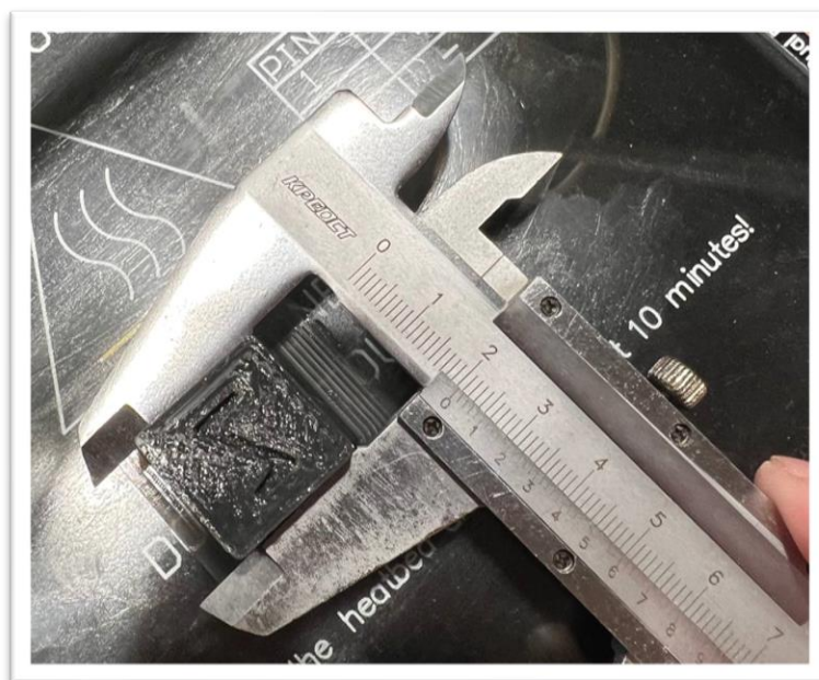
Рисунок 37 – Замер калибровочного куба по оси
