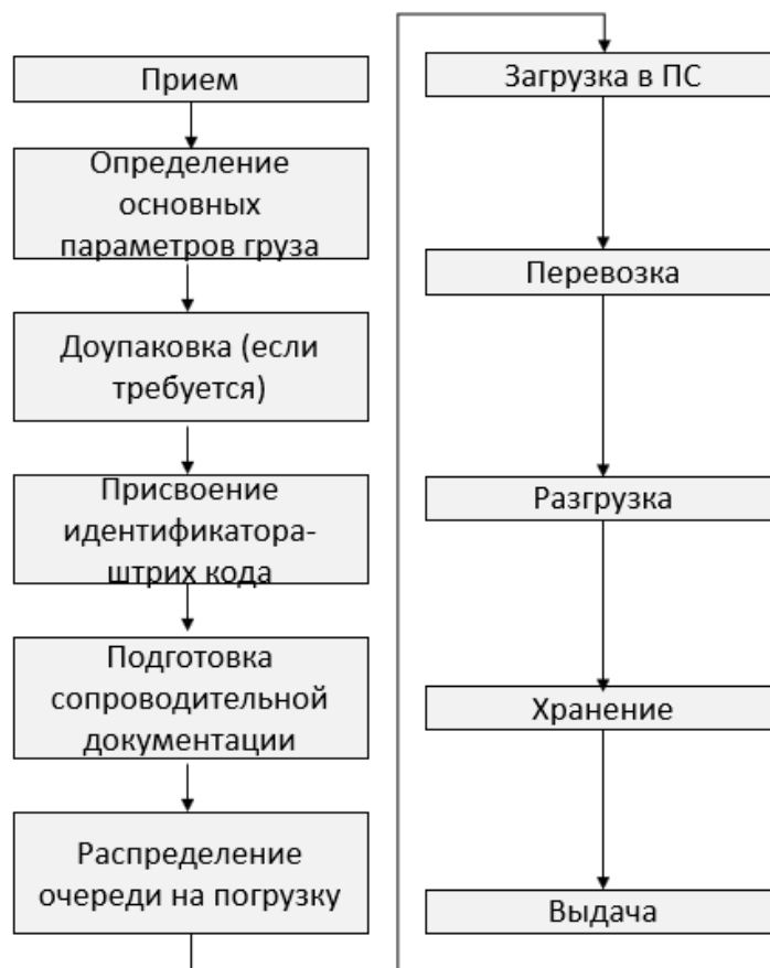
Рисунок 1.18 – Схема процесса доставки груза от терминала до терминала
