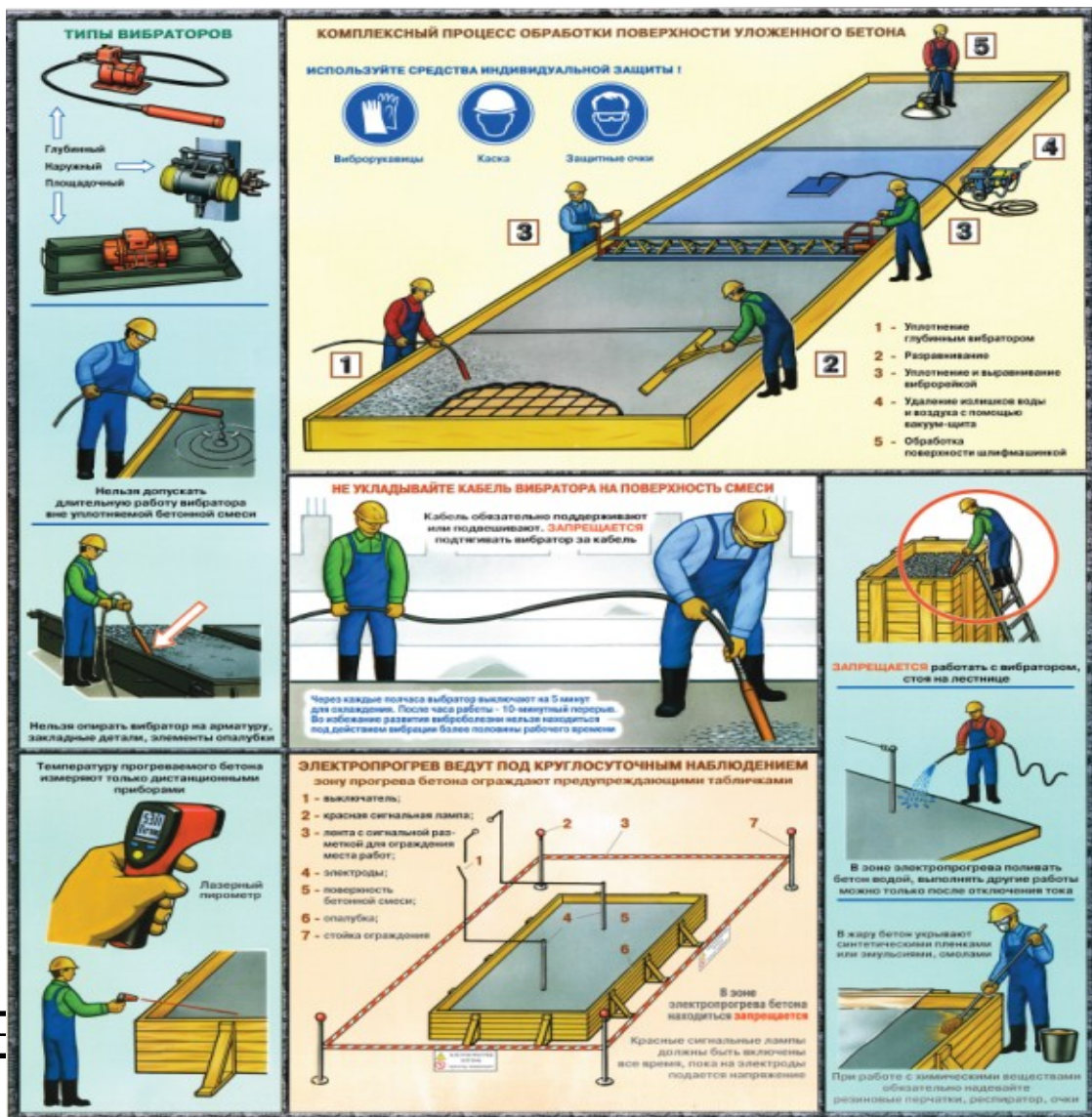
Рисунок 5.2 – Правила прогрева бетона
