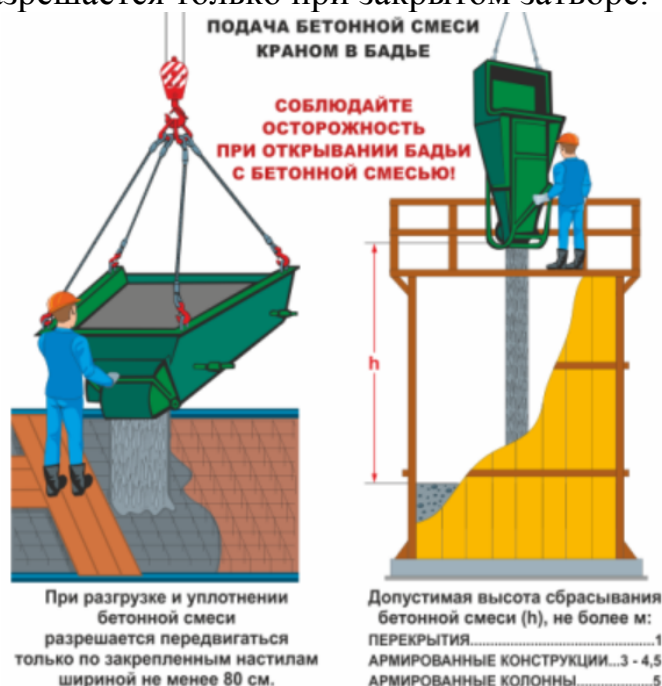
Рисунок 5.1 – Правила укладки бетона
